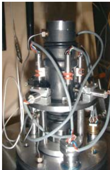
Photo II-4: Système de mesure de déformation local. Trois LVDTs mesurent la déformation axiale et quatre LVDTs mesurent la déformation radiale de l'échantillon.
