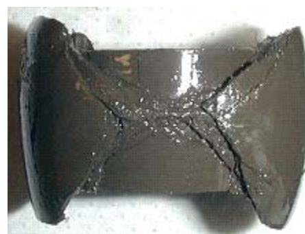
Photo IV-5 : Echantillon d'argile de Boom après un essai de cisaillement jusqu'à un niveau de déformation très important (essai BC06).
