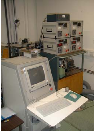
Photo II-2: Vue d'ensemble de la centrale d'acquisition et des régulateurs.
