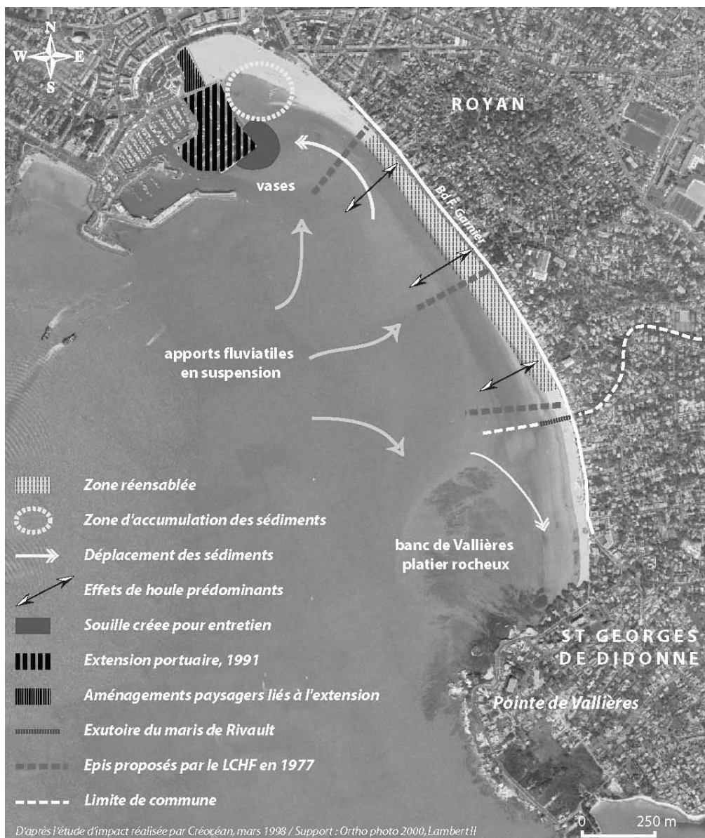
Figure 34 : Dynamique hydro – sédimentaire et projets d'aménagements
