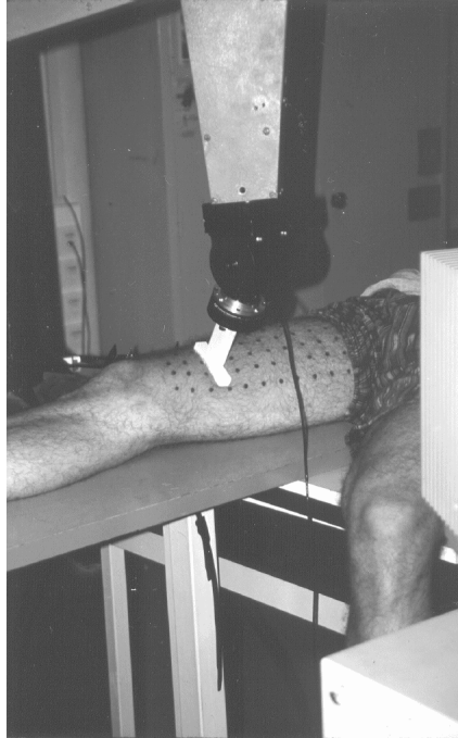
FIG. 2.4: Mesure des données force/déplacement effectuées à l'aide d'un robot Puma sur une cuisse humaine (source [dLC99]).
