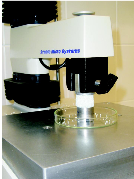
FIG. 4.19 – Vue d’ensemble du texturomètre utilisé pour la compression des échantillons granulaires cimentés par cristallisation de NaCl.
