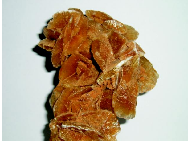
FIG. 1.4 – Un exemple de structure naturelle composée de grains liés par cimentation : la rose des sables.
