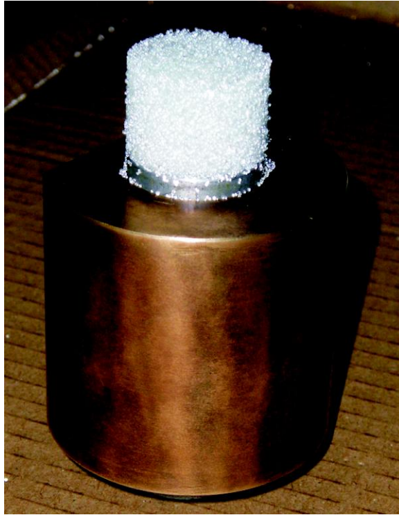
FIG. 3.19 – Échantillon constitué de billes de verre de diamètres compris entre 0,8 \text{ mm} et 1,3 \text{ mm} , pour une teneur en eau w = 3 \% .
