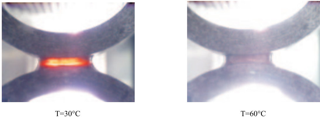
FIG. 4.3 – Effet de la température sur la géométrie d'un pont liquide pour une humidité relative HR = 100\% .
