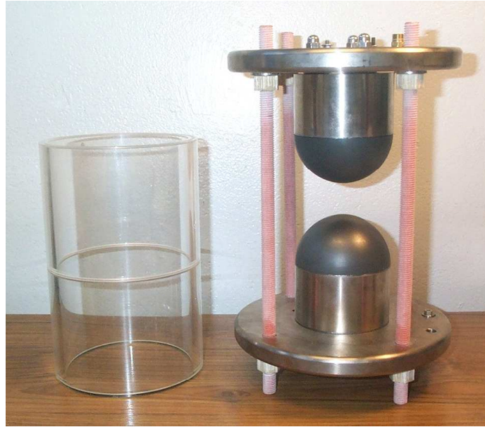
Figure 3.23 : Photographie d'un commutateur en graphite à deux électrodes et de son manchon de plexiglas
