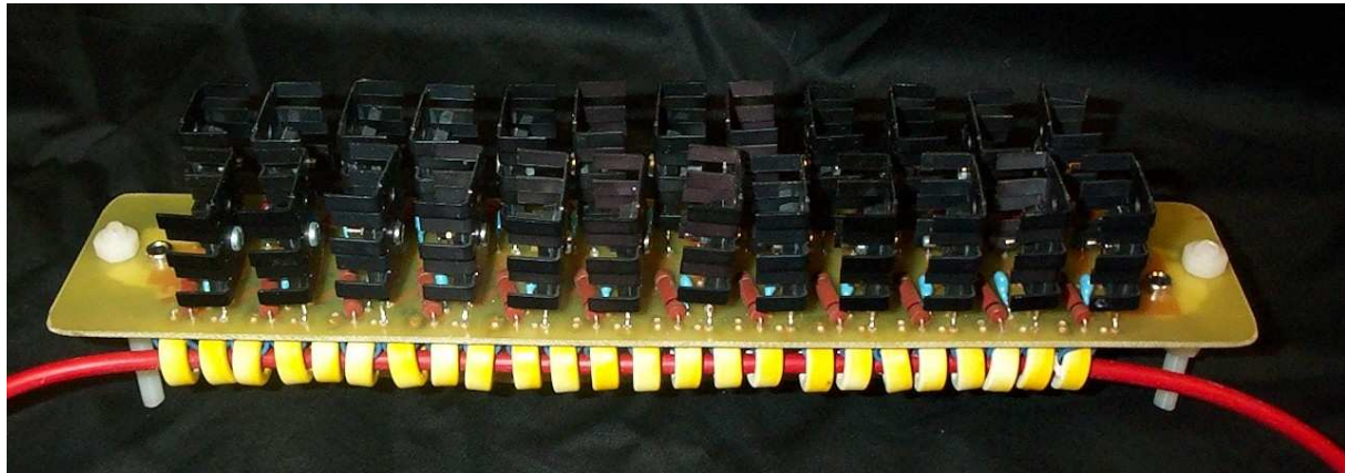
Figure 1.63 : Commutateur à thyristors équipés de dissipateurs à ailettes (24 thyristors montés en série)
