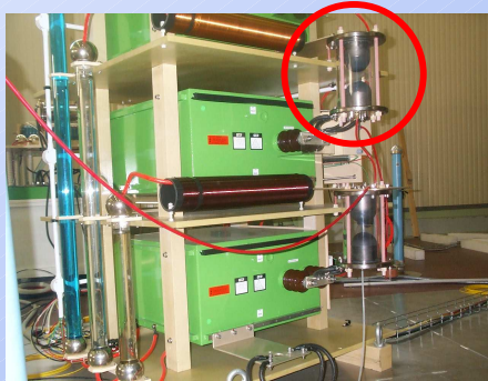
Modules de stockage capacitif + éclateurs à gaz pressurisé
