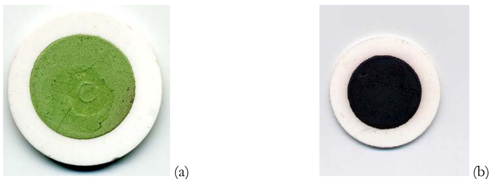
Figure V-1 : a. anode (NiO-YSZ) et b. cathode (LSM) sur électrolyte support (YSZ).
