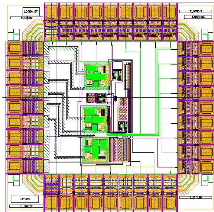
Figure 89 : Dessin de masque de l'interface générique pour capteurs piezorésistif et capacitif.
