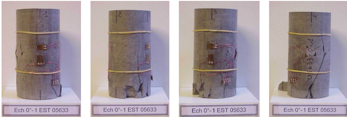
b) Échantillon 0^{\circ} -1 EST 05633 : vitesse de déformation = 10^{-6} s^{-1} .
