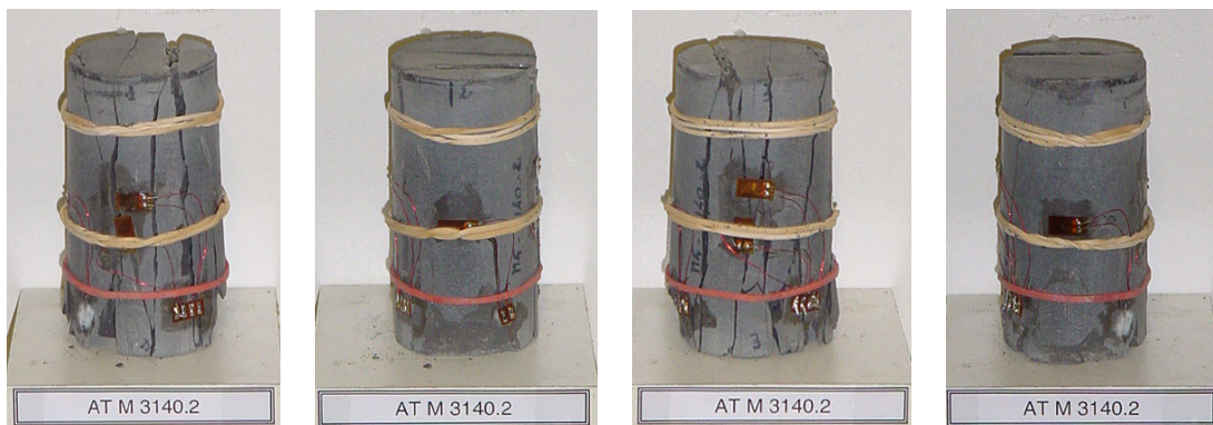
c) Échantillon AT M5 3140.2 : essai de fluage : rupture lors du fluage tertiaire sous 34,9 MPa.
