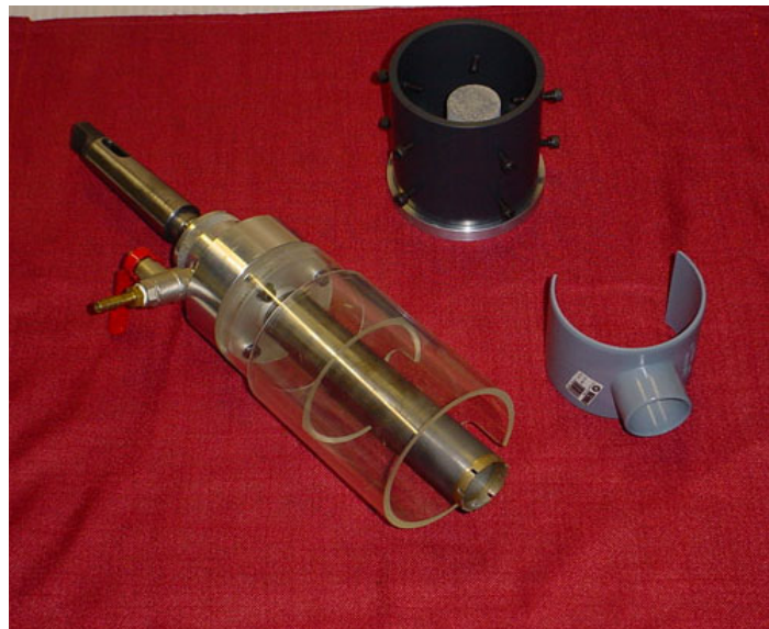
Figure 3.17 : Détail du système de confinement des poussières.
