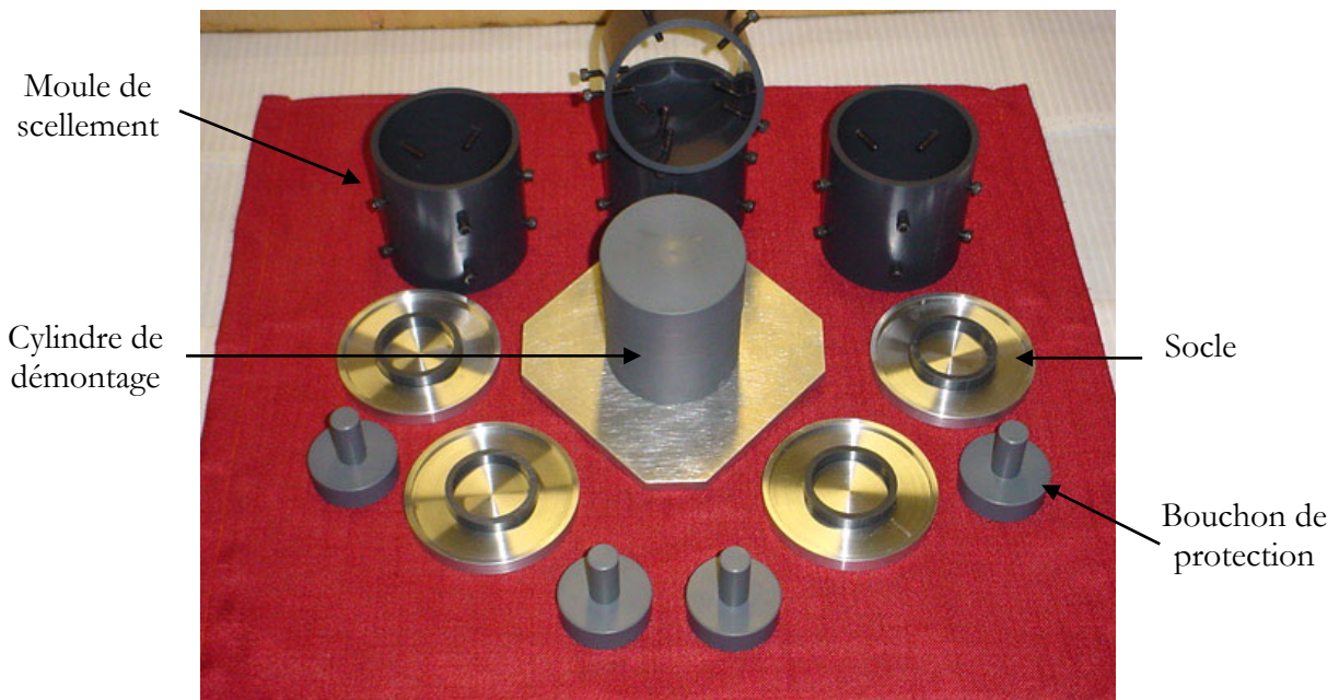
Figure 3.15 : Vue d'ensemble des moules de scellement pour le recarottage des échantillons.
