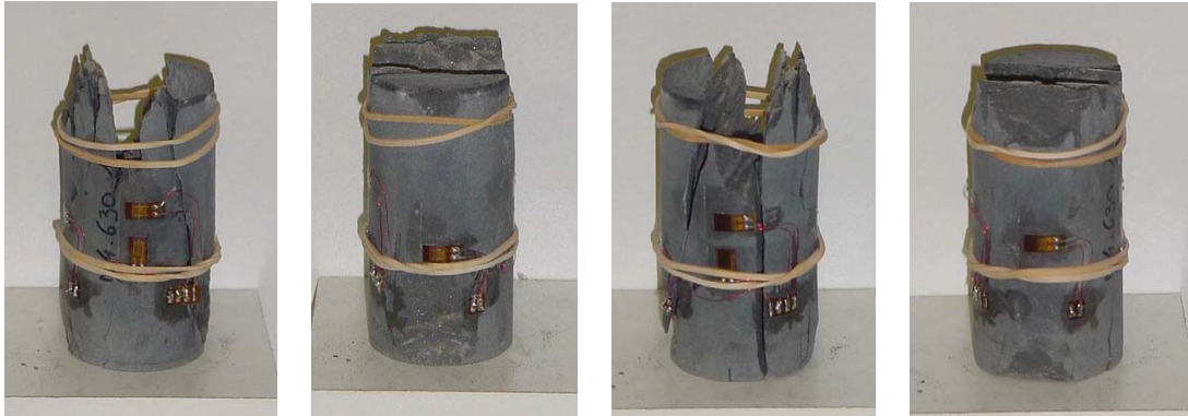
a) Échantillon AT M4 630.1 : essai de fluage : rupture lors de l'augmentation du déviateur de 36,8 à 39,6 MPa.
