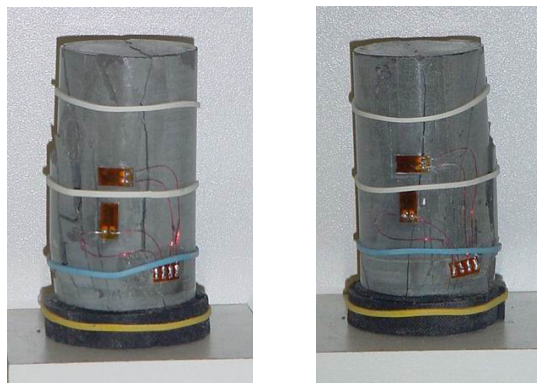
c) Échantillon MO 11.1 : vitesse de déformation = 8.10^{-9} s^{-1} .
