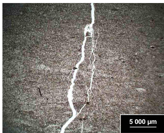
Figure 4.16 : Rôle des agrégats de pyrite dans le développement de la fissuration de l'échantillon 0°-2 EST 05633.
