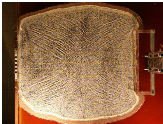
Figure 64 : Vue de dessus de « l'expérience 12 » à 28% de raccourcissement.
