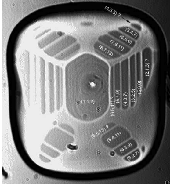
FIG. 1.12 : Monocristal facetté obtenu par croissance dendritique rapide sur du mica. On observe un grand nombre de facettes vicinales de la facette centrale (211). Les indices de Miller ont été déterminés par la méthode interférométrique décrite dans le texte.
