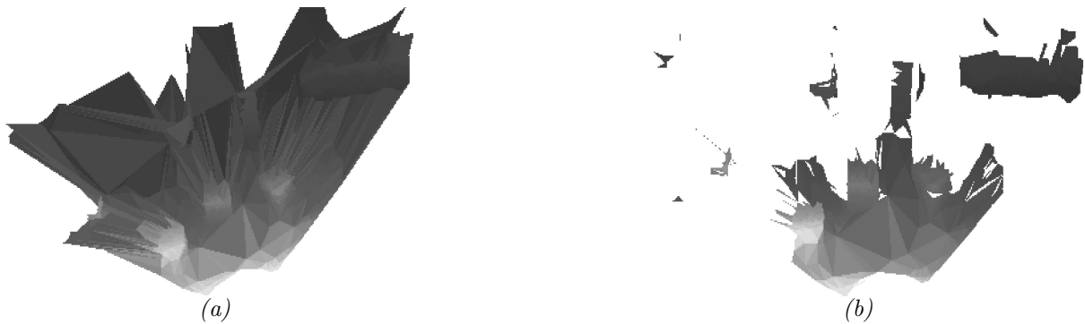
FIG. 2.12 – Filtrage successif d'un maillage : (a) maillage après le filtrage des facettes à l'horizon, (b) maillage après le filtrage de la densité et filtrage topologique.
