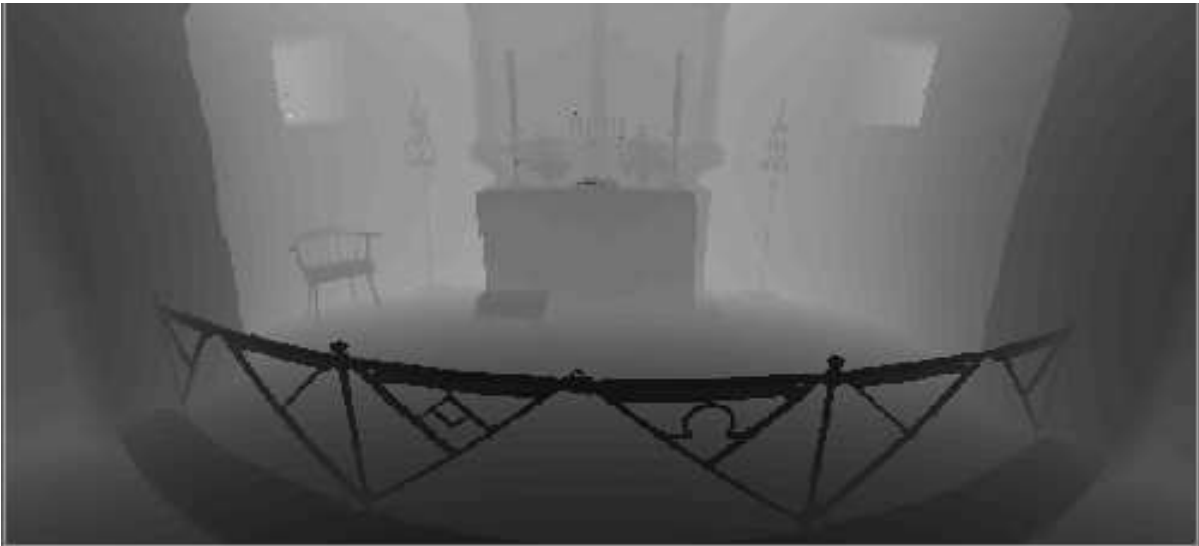
FIG. 2.6 – Sous-image centrée sur l'autel, d'une image de profondeur acquise dans une église.
