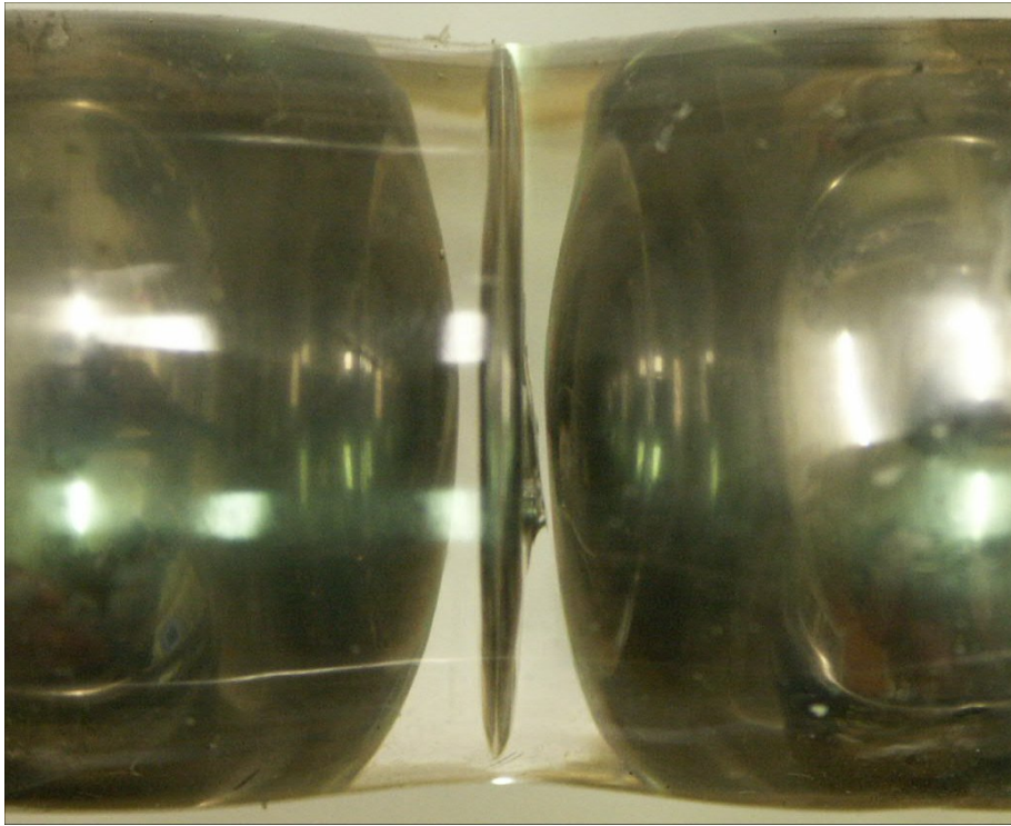
Photo III-77 - Photo du système à deux sphères moulé dans un élastomère transparent. La fissure se propage transversalement à la direction de sollicitation.
