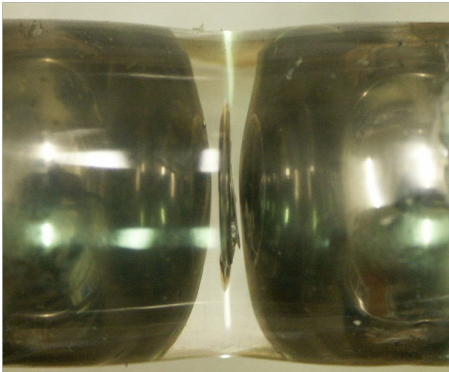
Photo III-76 - Photo du système à deux sphères moulé dans un élastomère transparent. La fissure apparaît très brutalement au niveau du plan séparant les deux sphères, et a une forme elliptique.
