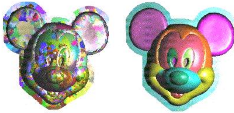
FIG. 2.10 – Segmentation par classification initiale (à gauche) et fusion. Sur le résultat (à droite), chaque grande zone a une couleur : le nez, chaque œil, chaque oreille, etc. (U Lyon1)
