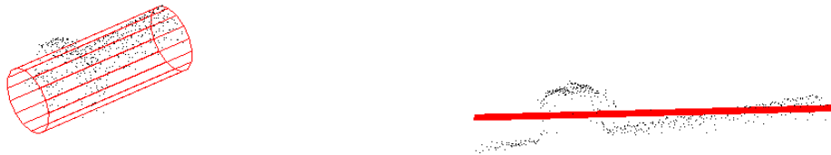
FIG. 5.23 – Ajustement de cylindre sur la scène «bride1» et surface de régression des résidus.
