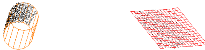
FIG. 5.20 – Ajustement de cylindre sur la scène «SynthCyl2» et surface de régression des résidus.
