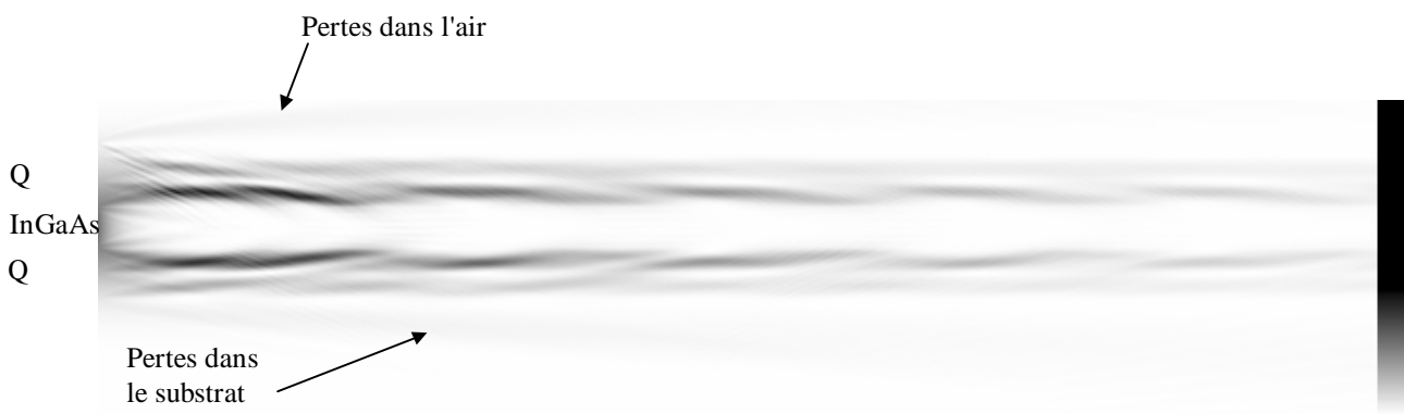
Figure III-1.10 : simulation de la propagation sur 100\ \mu\text{m} dans une structure symétrique à deux quaternaires et cœur absorbant de 3\ \mu\text{m} . On voit bien les pertes dans l'air et le substrat. \eta=89\ \% à \lambda=1,55\ \mu\text{m} .
