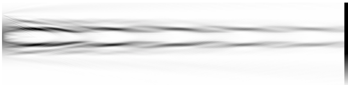
Figure III-1.13 : simulation de la propagation sur 100 \mu m . Cœur absorbant de 2 \mu m .
