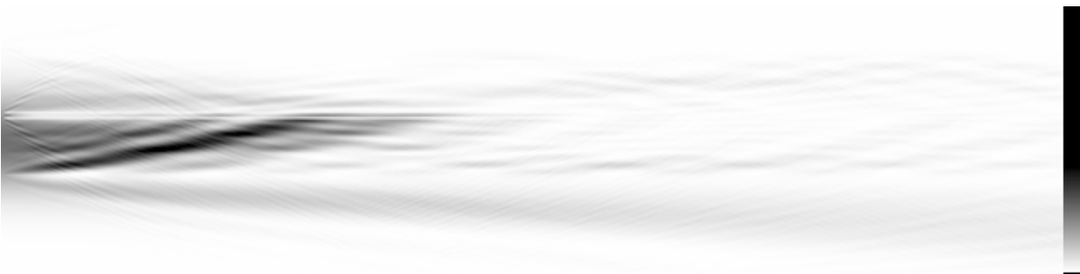
Figure III-1.22 : simulation de la propagation avec la fibre décalée de 2,5 \mu m vers le substrat. La lentille continue de remplir sa fonction. Les pertes dans le substrat augmentent (rendement quantique = 87 %).
