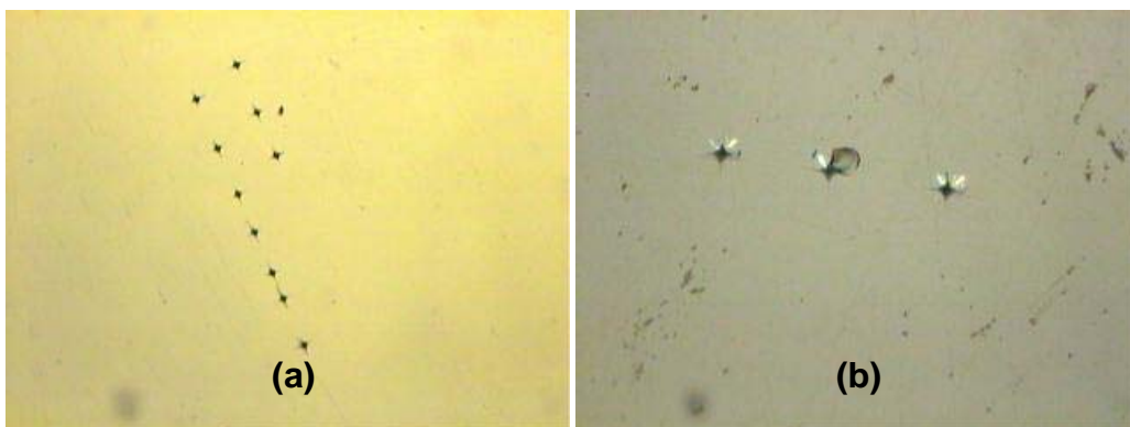
Figure 6.13 : (a) Empreintes d'indentation ( \approx 15 \mu\text{m} ) laissées sur le verre de composition 70 \text{ GeS}_2 - 25 \text{ Ga}_2\text{S}_3 - 5 \text{ CdCl}_2 ( \times 10 ). (b) Eclatements circulaires ( \approx 16 \mu\text{m} ) pour le verre de composition 40 \text{ GeS}_2 - 25 \text{ Ga}_2\text{S}_3 - 35 \text{ CdCl}_2 ( \times 20 ).
