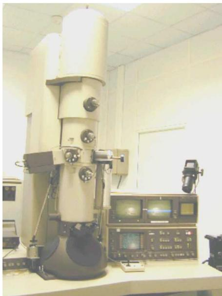
FIG. 2.3 – Microscope électronique à Transmission et à balayage FEG 20.
