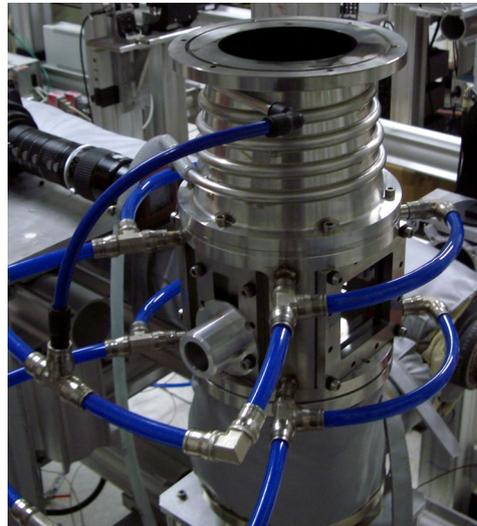
figure 93 : photo du brûleur monté
