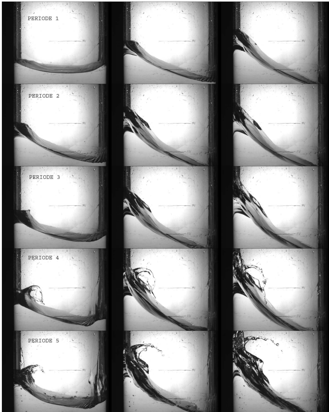
FIG. 5.11 – Vue de côté de la forme de l'onde. Cuve cylindrique en verre d = 158 mm remplie d'eau à h/R \approx 1.5 . Mise en mouvement depuis le repos à un forçage de fréquence \omega = 0.96\omega_{11} . Chaque ligne de clichés représente une période. Sur un même ligne, les clichés sont espacés de 66 ms, le dernier cliché de la ligne est la position maximale.
