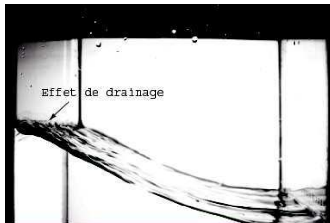
FIG. 3.19 – Allure typique du profil de l'onde au cours de la redescente du front.
