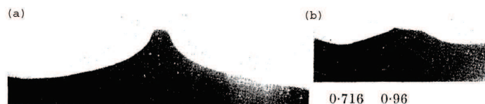
FIG. 1.11 – Développement d'instabilité de crête des ondes stationnaires d'après les expériences de Taylor [54]. Vues (a), longitudinale et (b), transverse.
