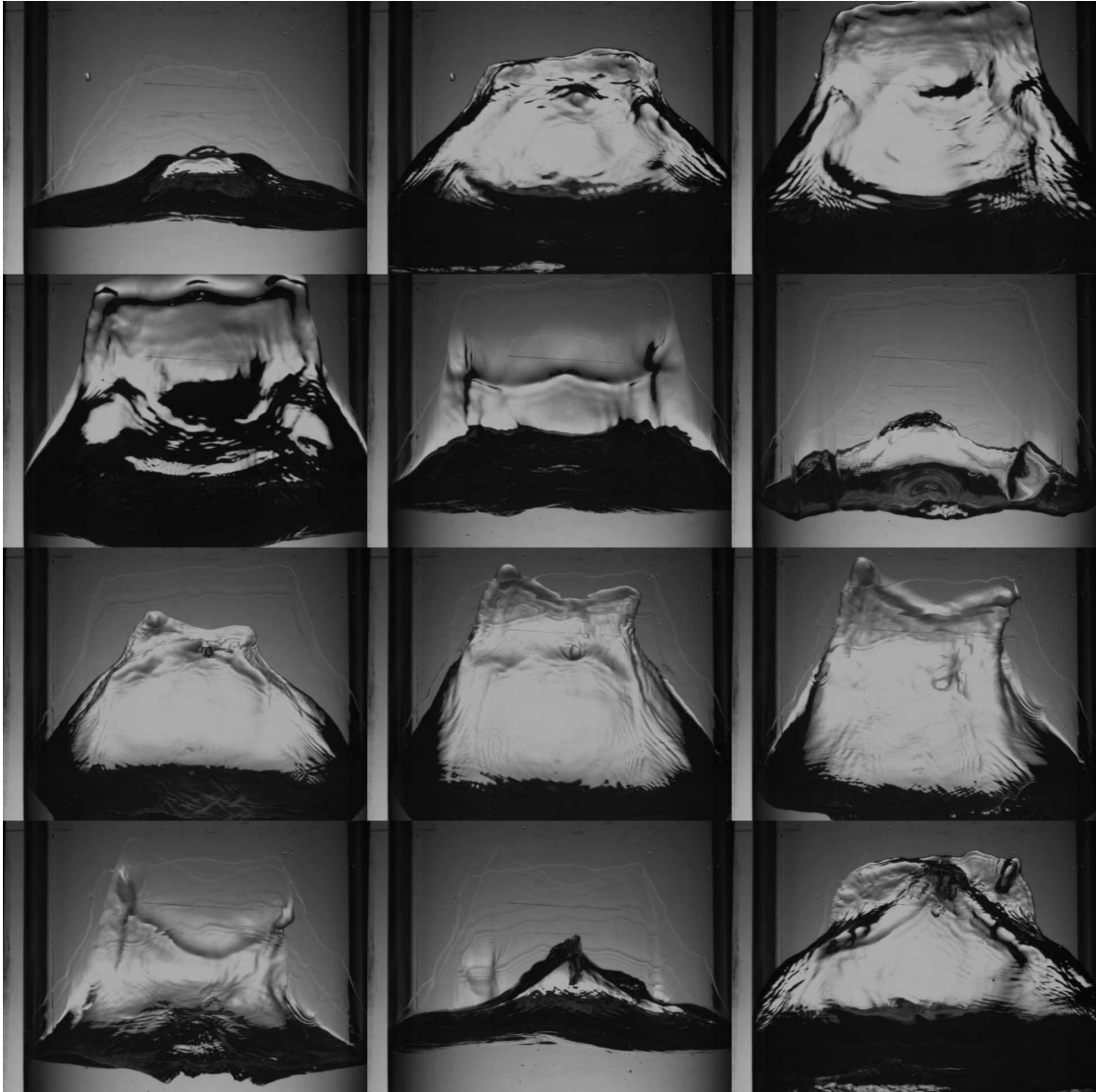
FIG. 5.2 – Installation du régime chaotique, croissance de l’onde : vues de face en cuve cylindrique en plexiglas de rayon R = 150 mm remplie d’eau. Le temps séparant deux clichés successifs est de 60 ms. Les lignes horizontales indiquent b_c sur chacune des faces du réservoir. h/R = 1.5 , \omega/\omega_{11} = 0.98 , A_f/R = 2.2 \cdot 10^{-3} . T \approx 600 ms.
