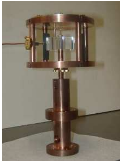
FIG. 3.7 – Photographie illustrant la version finale de cavité pour les résonateurs 50 \times 20\text{mm} .
