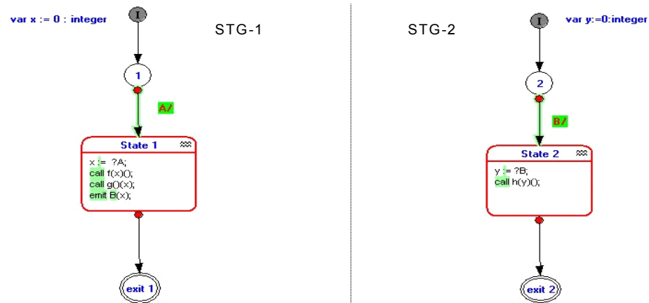
FIGURE 2.9. Exemple de communication entre deux STG
