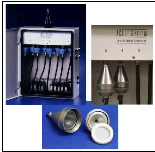
figure III-3 : Photos du système ACCU, avec les porte-filtres.
