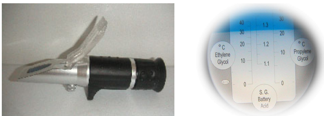
Figure 31 : Réfractomètre et son oculaire. Mesure de densités comprises entre 1,1 et 1,35\text{g.cm}^{-3}
