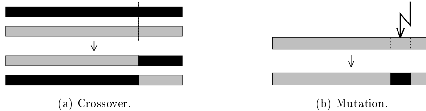
Figure 3.10: Exemple d'opérateur de recombinaison (crossover) et de mutation. Partant de deux solutions initiales (individus parents) l'opérateur de recombinaison engendre deux nouvelles solutions (enfants) en échangeant des informations des solutions initiales dans les nouvelles solutions. L'opérateur de mutation modifie une information élémentaire (gène) dans une solution pour engendrer une nouvelle solution potentielle.
