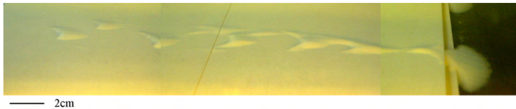
FIG. 4.14 – Couloirs de dunes créés à partir du point source le plus alimenté dans l'expérience "aquarium". On observe l'apparition de barchanes directement derrière l'amas de sable qui se crée sur le plateau supérieur. L'image de couverture de ce chapitre provient de ce même couloir de dune en vue de dessus. Il ressemble particulièrement aux corridors de dunes de la figure Fig. 4.13, mais à une échelle centimétrique.
