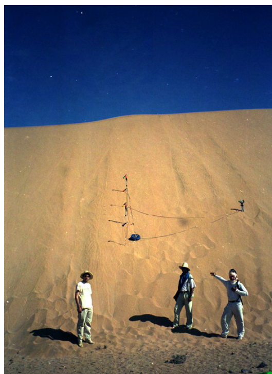
FIG. 8.5 – Protocole expérimental in situ . Pour obtenir un enregistrement représentatif de l'émission sonore, le montage suivant a été utilisé. Sur l'image on distingue les quatre micro disposés chacun à 3 m d'intervalle, et qui sont placés juste à côté du creux formé par le passage récent d'un expérimentateur poussant devant lui une avalanche de sable.
