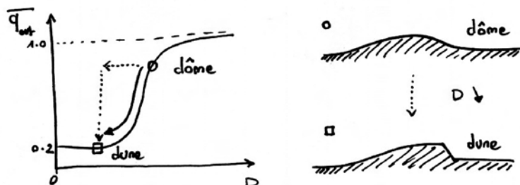
FIG. 3.25 – Transition dôme-dune. Une diminution du paramètre de diffusion D , pour des raisons quelconques, entraîne le changement de la seule forme d'équilibre acceptable vers une solution de type dune. Cette transition est d'autant plus facilitée, que la quantité relevante, le flux de sable d'équilibre varie rapidement quand D varie faiblement au voisinage des solutions de dômes stables.
