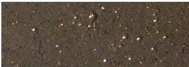
**Figure II.1 : Grossissement (x10) des gouttelettes de plomb métallique dans la phase pyrochlore  $Pb_2Ga_{0.5}Ta_{1.5}O_{6.5}$  après traitements thermiques sous  $Ar/H_2$  (5%)**
