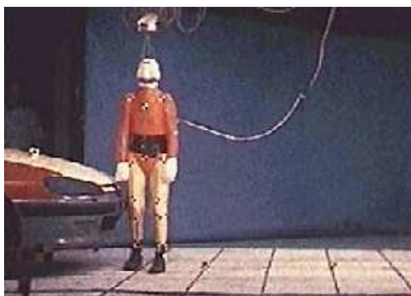
Fig. 2.1 - Image d'un film d'un choc latéral véhicule-piéton (Essai réalisé par le Laboratoire de Biomécanique Appliquée). La jambe droite est la première touchée.
