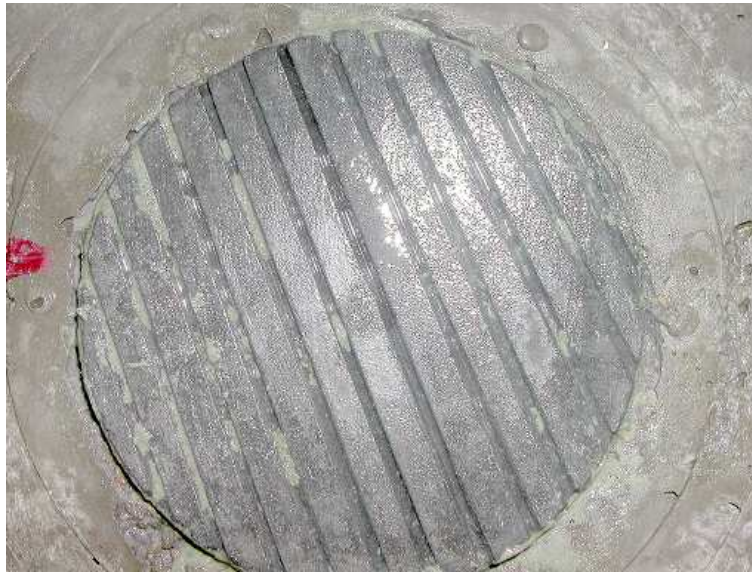
FIG. 4.7 – Marques laissées sur un échantillon de roche à la scie à métaux. Photo prise après essai.
