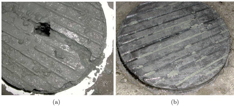
FIG. 5.21 – Essai 1BR70 : marques laissées par l’eau sur les deux épontes, mise en évidence de l’écoulement dans un canal. (a) Partie bentonite. (b) Partie argilite.
