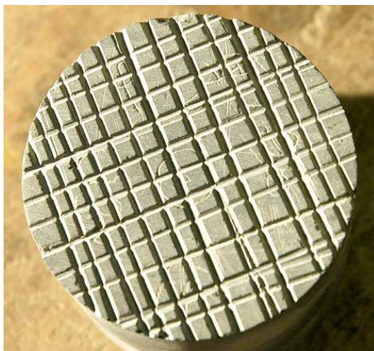
FIG. 4.4 – Surface quadrillée à la lime d'un échantillon d'argilite ( \phi 63 mm). Profondeur maximale des rainures : 1 mm.
