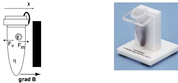
FIG. 1.5 – Principe de la séparation magnétique : la particule est soumise à une force magnétique qui attire la particule vers l’aimant et une force de friction qui s’y oppose. Sur le cliché, le surnageant est devenu limpide signe que toutes les particules sont regroupées sur la paroi de l’éppendorf en contact avec l’aimant (Cliché extrait de www.qiagen.com )
