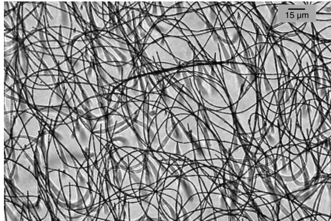
FIG. 2.22 – Longs filaments ( \phi=0.1\% vol) calibrés ( 200\ \mu\text{m} de long) fabriqués avec du PAA ( 0.1\% en masse) dans une cellule de 200\ \mu\text{m} d'épaisseur. Clichés C.G.
