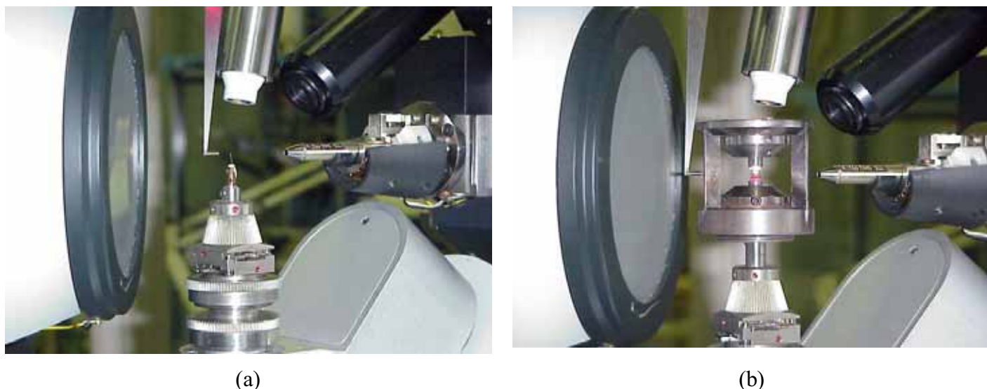
figure II.9. Encombrement de la cellule de pression sur le diffractomètre NONIUS \kappa -CCD. Vue d'une expérience classique (a) et d'une expérience avec la cellule de pression (b).
