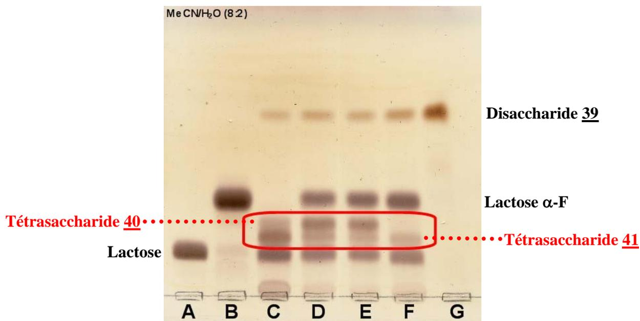
Figure 48 : Analyse par CCM du couplage entre le donneur de lactosyle **16** et l'accepteur **39** après 24 h d'incubation.
