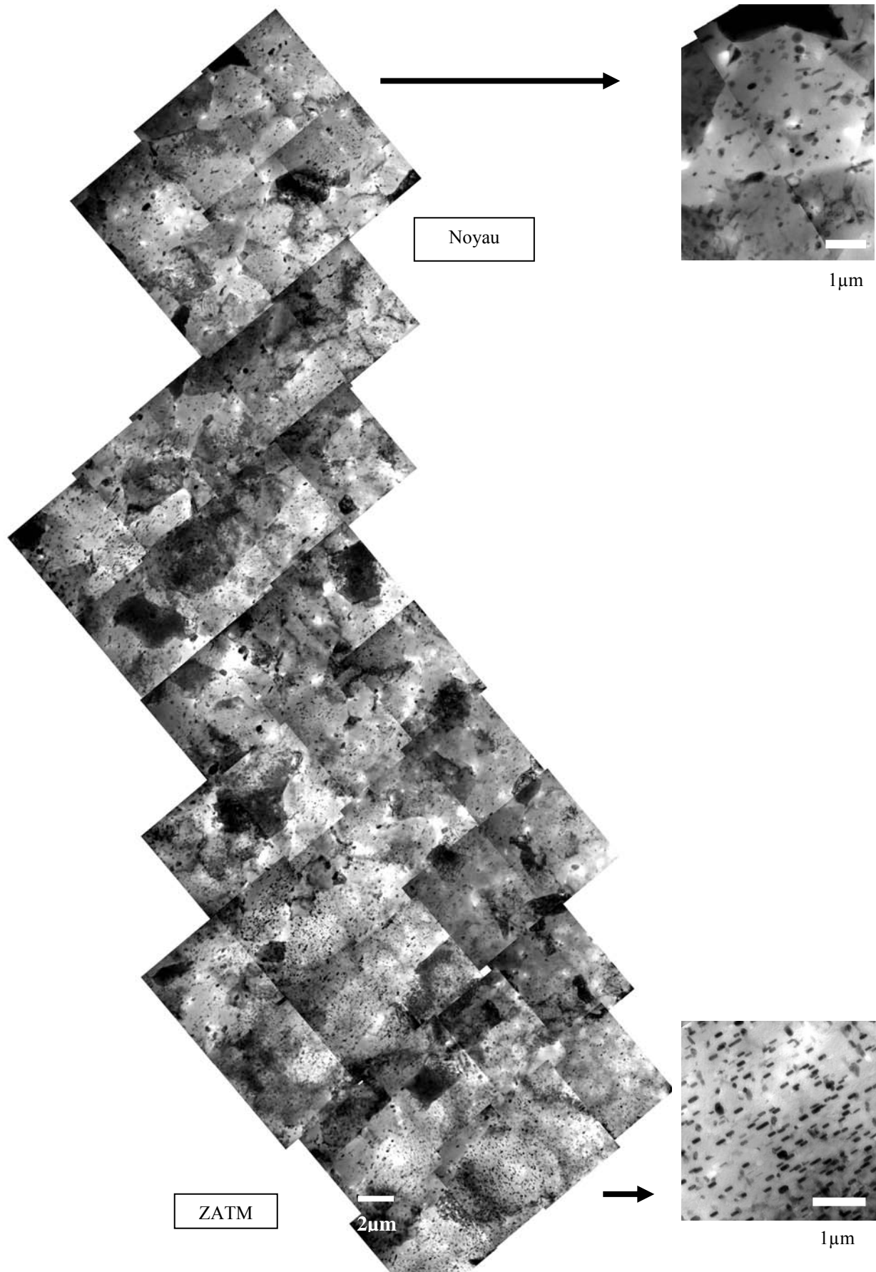
Fig.III.40 Transition Noyau / ZATM (AS) Cartographie en transmission (MET) en champ clair
