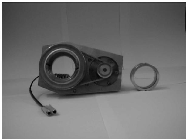
FIG. 2.27 – Cellule tournante utilisée dans les expériences pompe-sonde.
