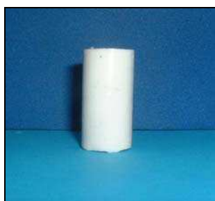
Figure 2.5 géopolymère après chauffage à 60°C
