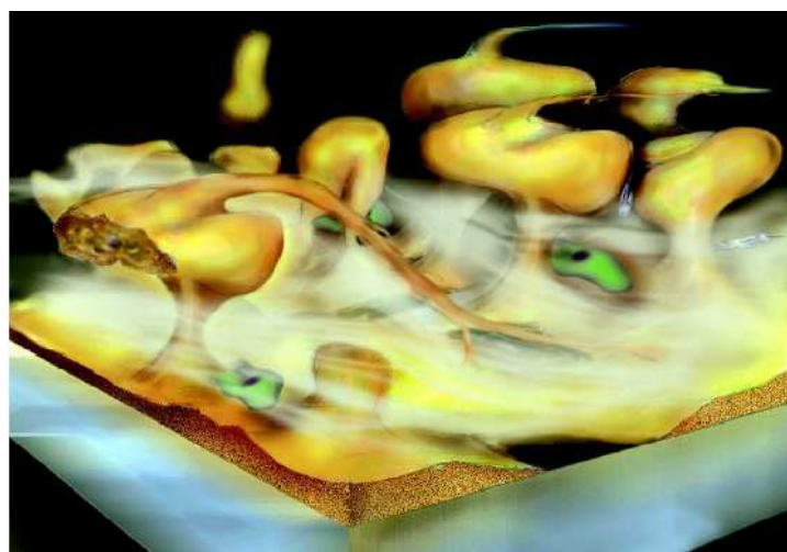
FIG. 2.3 – Représentation d'un biofilm développé dans une canalisation d'eau potable (PR-Company GmbH, 2004)
