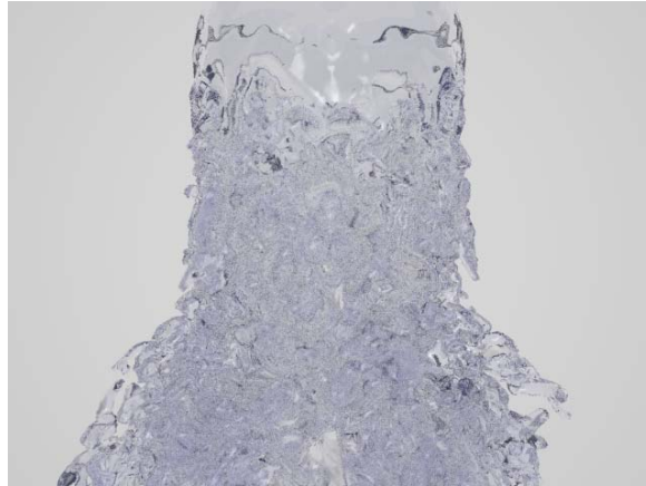
Figure (6.19) : profil d'interface simulé en sortie proche de l'injecteur pour le jet coaxial avec \rho_G = 98 \text{ kg.m}^{-3}
