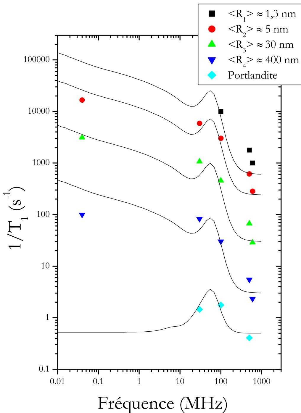
FIG. 3.8 – Évolution en fonction de la fréquence d'observation des vitesses de relaxation mesurées sur une pâte de  $C_3S$ -b hydraté à  $e/c = 0,4$  pendant trois mois. Les courbes de dispersion ainsi obtenues peuvent être ajustées par l'expression 3.17. Les courbes en trait continu correspondent au meilleur ajustement.
