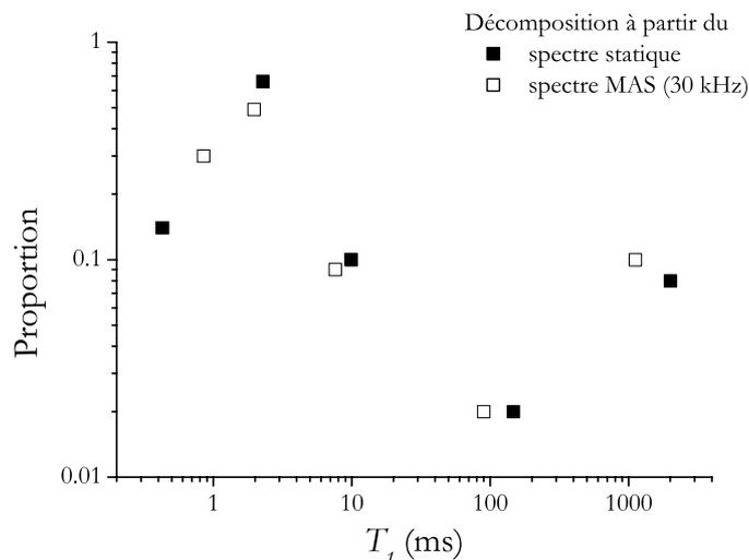
FIG. 3.10 – Superposition des distributions de temps de relaxation calculées sur une pâte de  $C_3S-b$  hydraté 3 mois à  $20\text{ }^\circ\text{C}$ ,  $e/c = 0,4$ , à partir de spectres  $^1\text{H}$  statiques et MAS (30 kHz).
