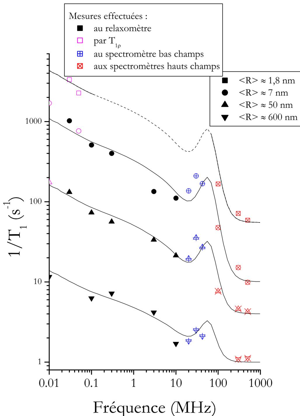
FIG. 3.3 – Évolution en fonction de la fréquence d'observation des quatre vitesses de relaxation mesurées sur une pâte de  $C_3S$ -a hydraté à  $e/c = 0,4$  pendant un an. Les symboles choisis pour les points correspondent à une famille de temps de relaxation donnée et leur remplissage correspond à l'appareil utilisé. Les courbes de dispersion ainsi obtenues peuvent être modélisée par l'expression 3.17. Les courbes en trait continu correspondent au meilleur ajustement.
