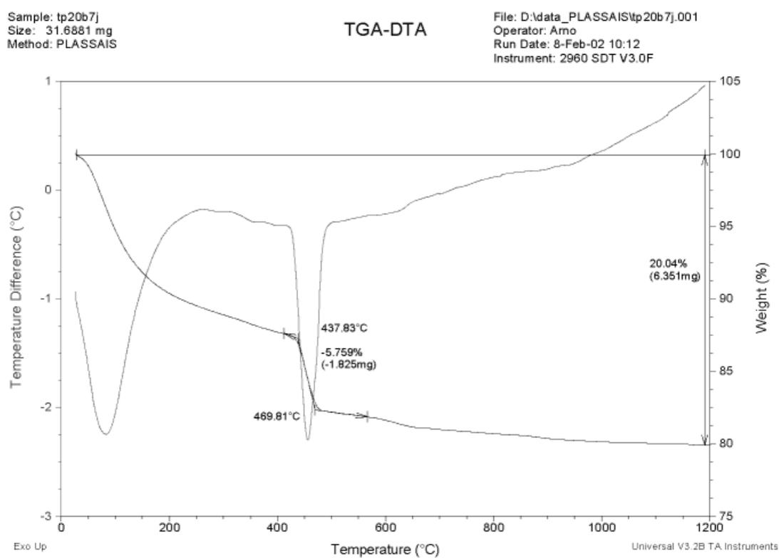
FIG. 2.17 – Exemple de courbes en ATD/ATG obtenues sur un  $C_3S$  hydraté. Pâte de  $C_3S$ -b hydraté 7 jours à  $20^\circ C$ .
