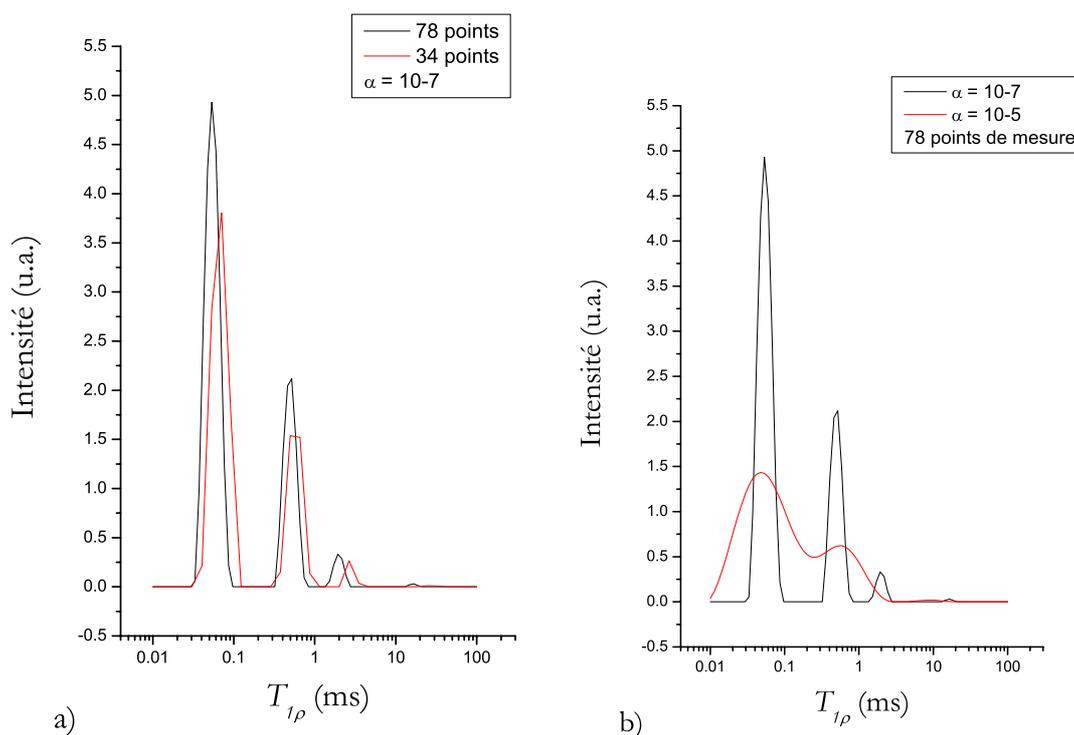
FIG. 2.12 – Distribution des proportions de temps de relaxation obtenues par CONTIN. Décomposition d'une courbe de relaxation  $T_{1\rho}$  mesurée sur une pâte de  $C_3S$ -a hydraté 4 mois à 20 °C en fonction a) du nombre de points de mesure et b) de la valeur du paramètre de parcimonie. La forme des pics est modifiée, mais leur aire et leur position sont pratiquement inchangées.
