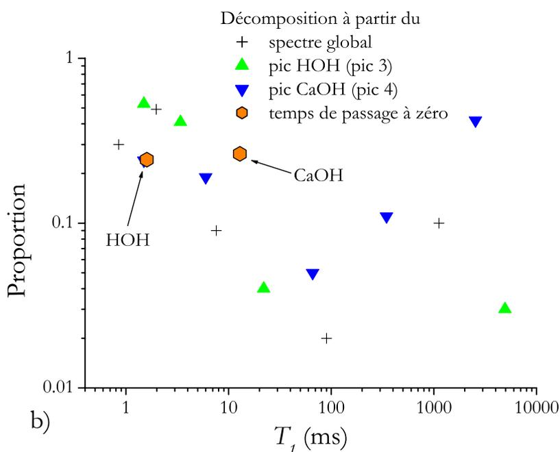
FIG. 3.12 – Superposition des distributions de temps de relaxation d'une pâte de  $C_3S$ -b hydraté 3 mois à  $20^\circ C$  et des temps de relaxation relatifs aux différents sites spectroscopiques (mesures par passage à zéro et par décomposition des courbes de relaxation). a) espèce correspondant au pic 1 et au pic 2, b) espèce correspondant au pic 3 et au pic 4.
