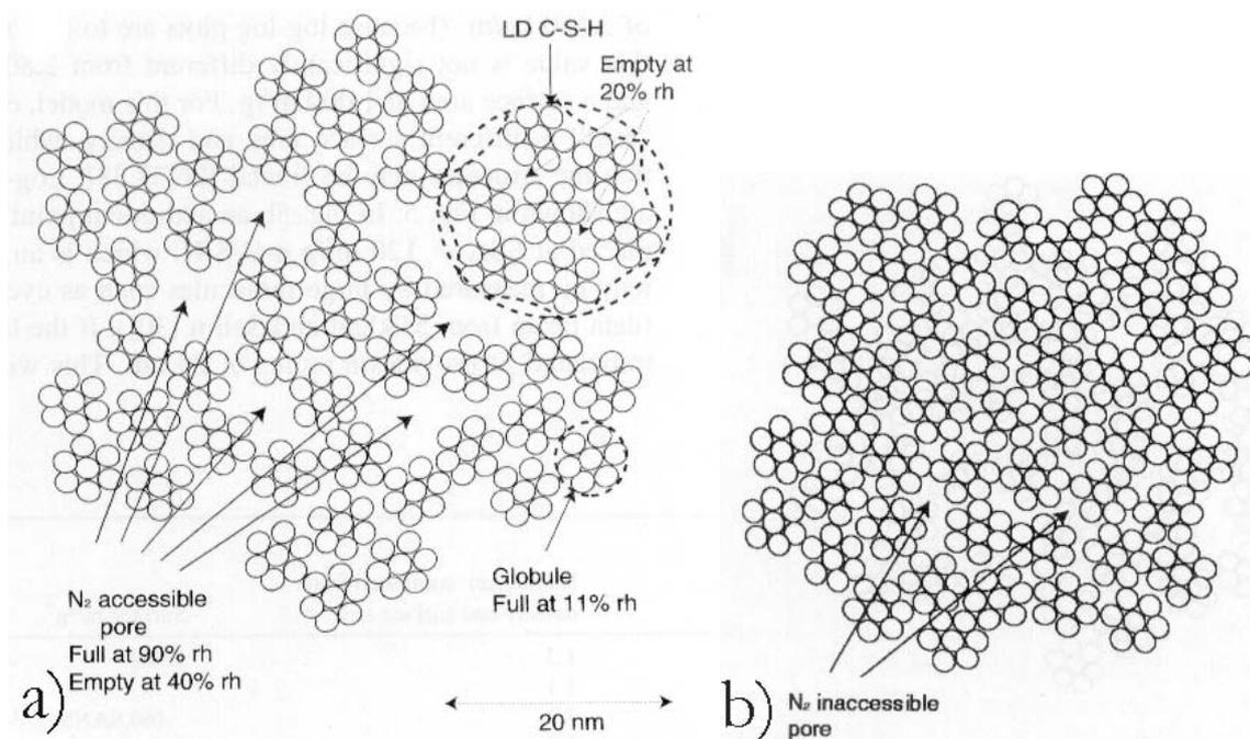
FIG. 1.3 – Schémas de microstructure d'après Jennings [13]. L'agrégation des particules de C-S-H de quelques nanomètres et de surface spécifique élevée s'effectue de deux façons et forme a) un *LD C-S-H* et b) un *HD C-S-H*. L'accessibilité vis-à-vis de l'adsorption de  $N_2$  n'est pas la même.
