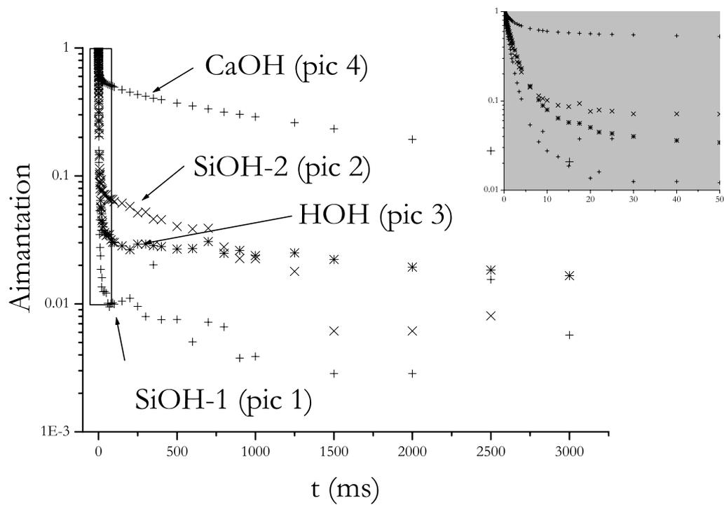
FIG. 3.11 – Courbes de relaxation correspondant à l'inversion-récupération des 4 pics qui composent les spectres  $^1H$  MAS d'une pâte de  $C_3S$ -b hydraté 3 mois à  $20^\circ C$ ,  $e/c=0,4$ . Le graphique sur fond gris est un agrandissement pour les faibles taux de relaxation.
