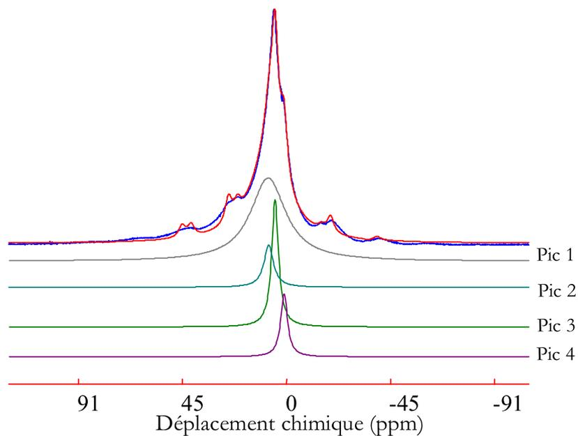
FIG. 2.3 – Décomposition en quatre raies du spectre  $^1\text{H}$  MAS d'une pâte de  $\text{C}_3\text{S-b}$  hydraté, réalisé sur spectromètre 500 MHz à 10 kHz de rotation.
