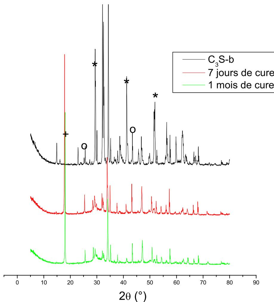
FIG. 2.18 – Superposition des diffractogrammes du  $C_3S$ -b anhydre et hydraté 7 jours et 1 mois à  $20^\circ C$ . Le premier et le dernier contiennent 10 % d'alumine, le deuxième en contient 20 %. Une partie des attributions de pics est donnée pour la portlandite (+), le  $C_3S$  (\*) et l'alumine (o).
