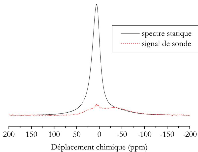
FIG. 2.1 – *Superposition d'un spectre  $^1\text{H}$  statique obtenu par impulsion unique à 500 MHz sur une pâte de  $\text{C}_3\text{S}$  hydraté 3 mois et du signal de sonde mesuré dans les mêmes conditions sur le rotor vide.*
