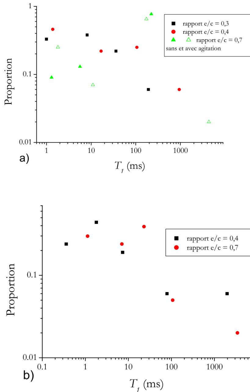
FIG. 5.2 – Distribution des temps de relaxation mesurée à 500 MHz sur des pâtes de  $C_3S$ - $b$  hydraté en fonction de leur rapport  $e/c$ . a) Pour un temps de cure de 7 jours, b) pour un temps de cure de 3 mois.
