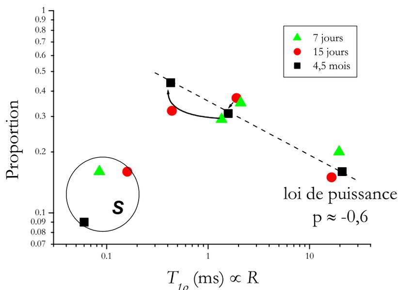
FIG. 4.5 – Superposition des distributions de  $T_{1\rho}$  mesurées à 500 MHz sur une pâte de  $C_3S-a$  hydratée avec un rapport  $e/c=0,4$  à  $20^\circ C$  pour des temps de cure supérieures à sept jours. Il y a dissociation des échelles de porosité jusqu'à la formation d'une loi de puissance.
