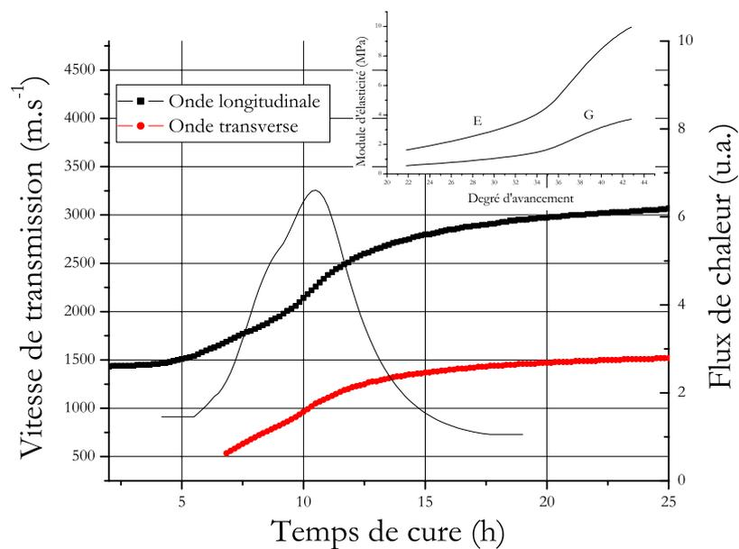
FIG. 4.3 – Évolution des vitesses de propagation des ondes ultrasonores et du flux de chaleur en fonction du temps de cure mesuré sur une pâte de CEM I hydraté à  $e/c = 0,4$ . L'évolution des modules d'élasticité est également représenté en fonction du degré d'avancement : ces grandeurs varient pratiquement linéairement avec la quantité d'hydrate formés.
