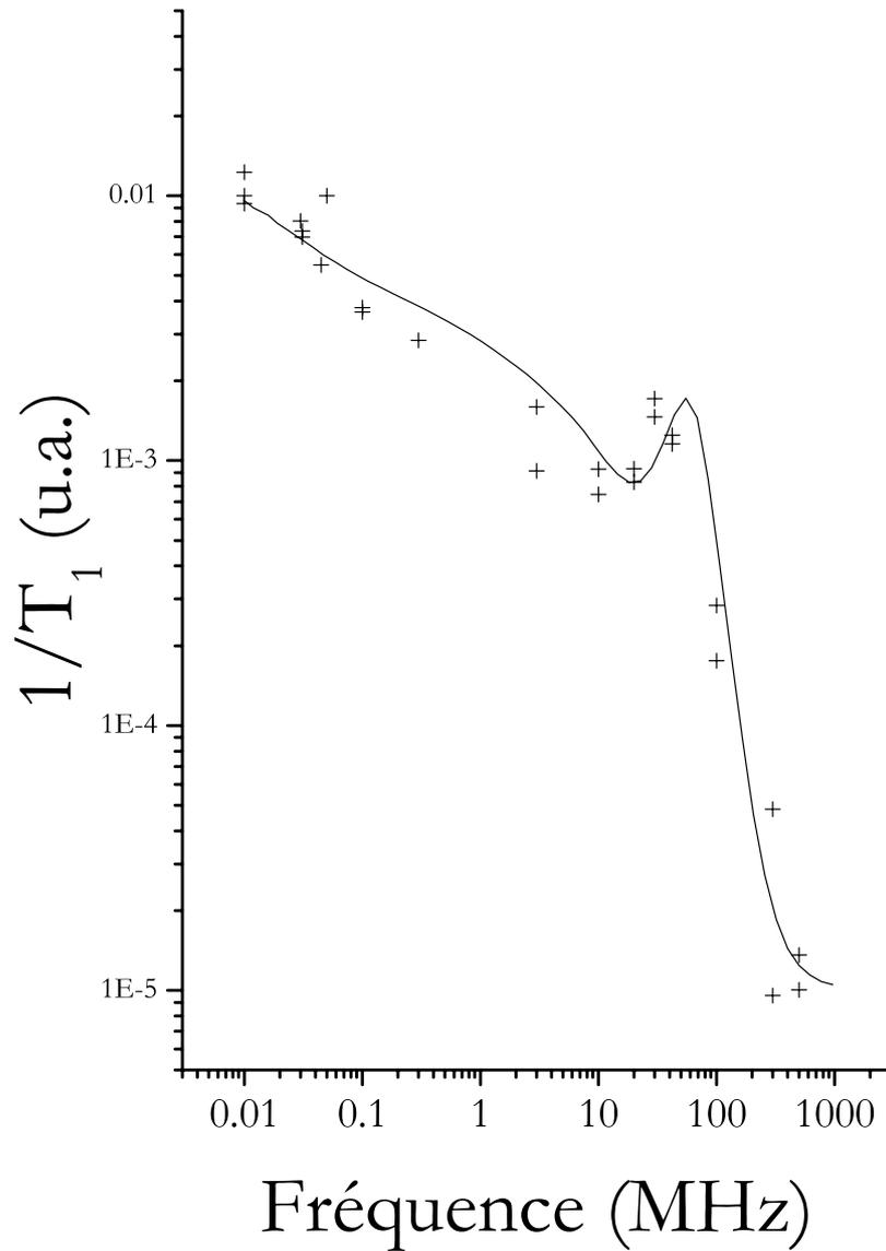
FIG. 3.4 – Superposition des courbes de dispersion des temps de relaxation après renormalisation des données de la figure 3.3. La courbe en trait continu correspond au meilleur ajustement. Cette renormalisation démontre que les mécanismes de relaxation des quatre courbes de dispersion de la figure 3.3 sont identiques. Seul le rapport  $S_i/V_i \propto 1/R_i$  change.
