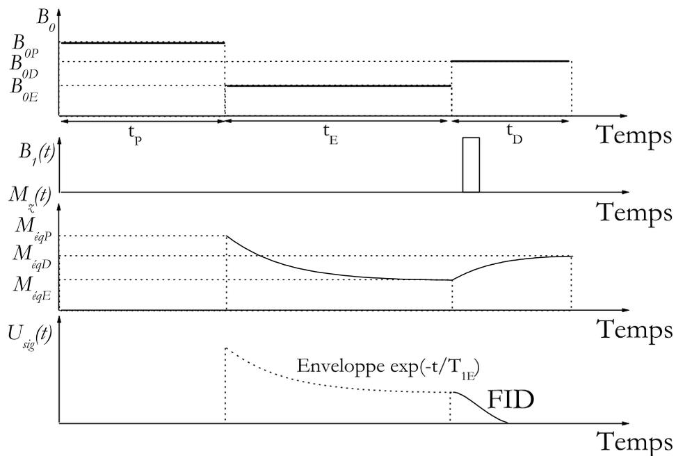
FIG. B.5 – Séquence de champ cyclé avec prépolarisation, pour mesurer la dépendance en champ magnétique (donc en fréquence) des temps de relaxation longitudinale. De haut en bas : cyclage de champ  $B_0$ , impulsion du champ radiofréquence  $B_1(t)$ , aimantation longitudinale  $M_z(t)$ , signal d'induction nucléaire  $U_{sig}(t)$ .
