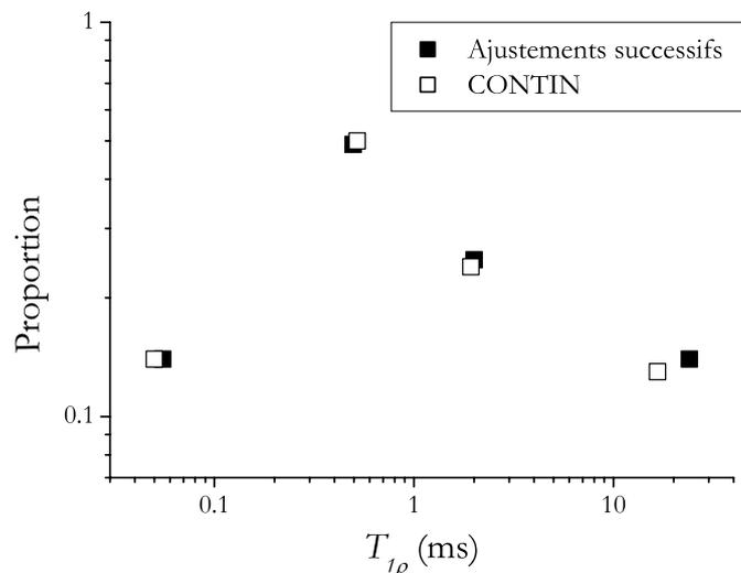
FIG. 2.13 – *Superposition des distributions des proportions de temps de relaxation obtenues par ajustements progressifs et par CONTIN. Dans le cas de la décomposition par CONTIN, les temps de la distribution discrète sont les centres des pics de la figure précédente, leurs proportions sont les aires des pics. Les deux méthodes donnent des décompositions similaires.*
