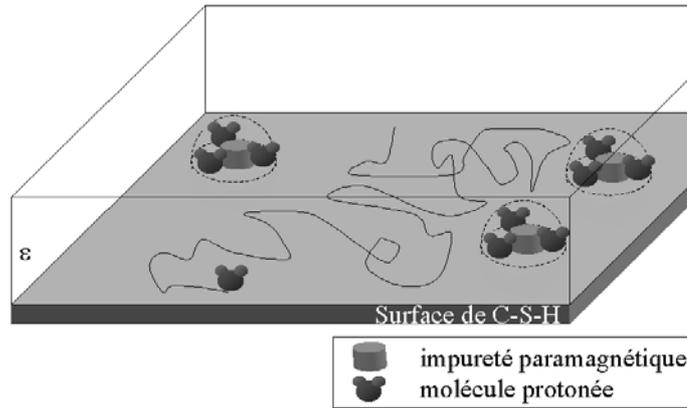
FIG. 3.6 – Représentation schématique des modulations des interactions dipolaires entre les spins  $I$  (porté par des molécules protonées) et  $S$  (spin électronique porté par un ion paramagnétique). Les modulations sont pour partie dues à la diffusion translationnelle des spins  $I$  par rapport aux spins  $S$  et pour partie dues à la relaxation du spin  $S$ .
