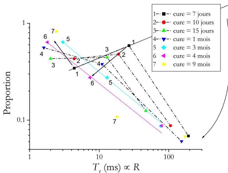
FIG. 4.6 – Superposition des distributions de  $T_1$  mesurées à 500 MHz sur une pâte de  $C_3S$ -b hydraté à  $e/c = 0,4$  et à  $20^\circ C$  pour des temps de cure supérieurs à sept jours. Le  $T_1$  solide n'est pas représenté, les proportions sont renormalisées par rapport au trois temps représentés.
