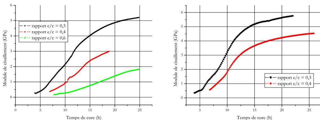
FIG. 5.3 – Évolution du module de cisaillement pour deux rapports  $e/c$  différents.
