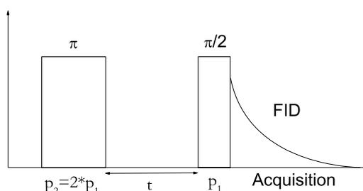
FIG. B.2 – Schéma de la séquence d'inversion-récupération.
