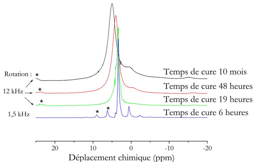
FIG. 4.2 – Évolution avec le temps de cure du spectre  $^1\text{H}$  MAS d'une pâte de  $\text{C}_3\text{S}$  – a hydratée ( $e/c=0,4$ ). la vitesse de rotation est indiquée sur la figure. Les bandes de rotation sont marquées \*.
