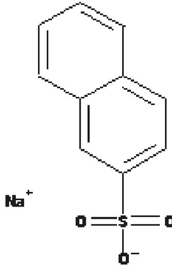
FIG. A.1 – Formule développée de superplastifiant utilisé
