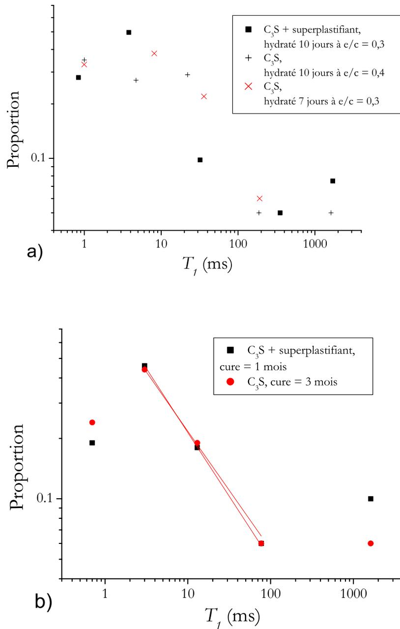
FIG. 5.10 – Superposition des distributions de temps de relaxation de pâtes de  $C_3S$ -b hydraté avec et sans superplastifiant pour une pâte curée a) moins de 10 jours et b) plus d'un mois. Les rapports  $e/s$  sont indiqués.
