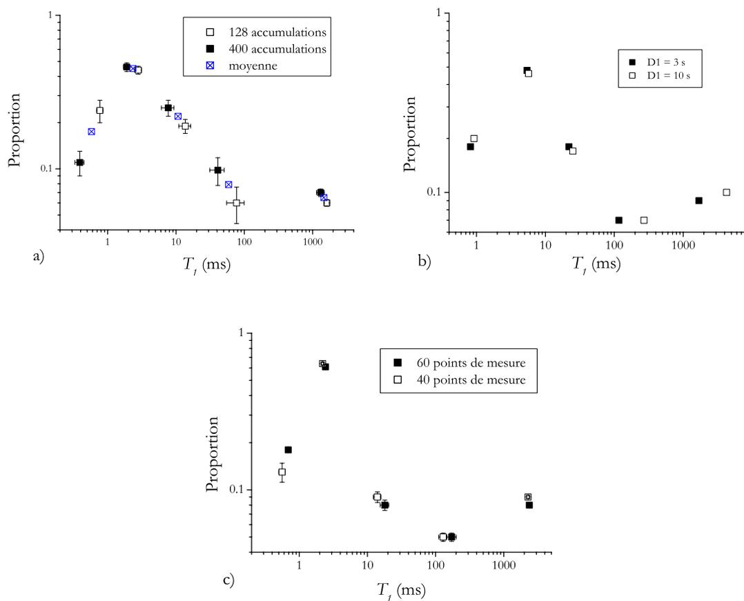
FIG. 2.11 – Influence des paramètres d'acquisition RMN sur la distribution de temps de relaxation pour une pâte de  $C_3S-b$  hydraté : a) influence du rapport signal sur bruit, b) influence du  $D_1$ , c) influence du nombre de points de mesure.
