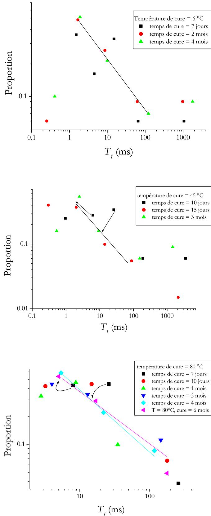
FIG. 5.6 – Évolution de la distribution de temps de relaxation pour des temps de cure supérieurs à 7 jours, déterminée sur des pâtes de C<sub>3</sub>S-b hydraté à a) 6 °C, b) 45 °C et c) 80 °C;  $e/c = 0,4$ .
