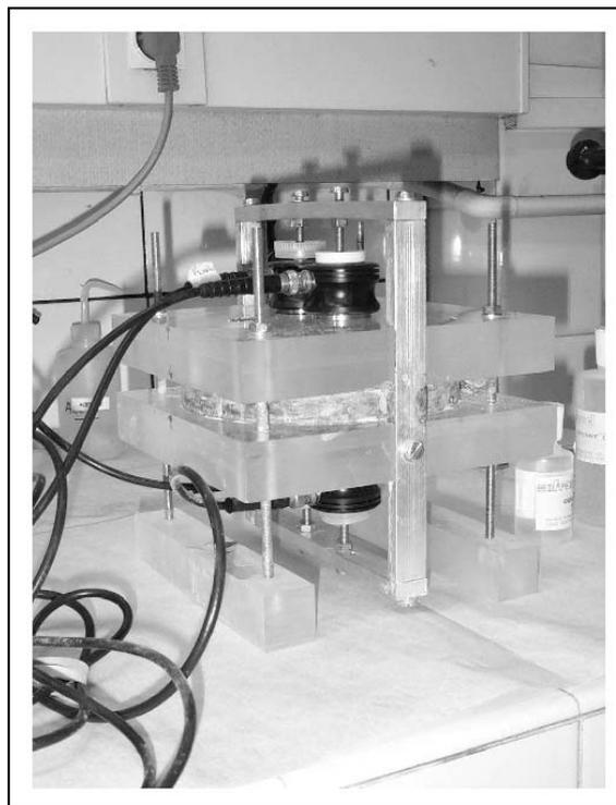
FIG. 2.21 – Photographie de la cellule de mesure avec les deux plaques de plexiglas et les quatre transducteurs piézo-électriques (deux pour les ondes longitudinales et deux pour les transverses). Le ciment est contenu dans le cylindre métallique pris entre les deux plaques.
