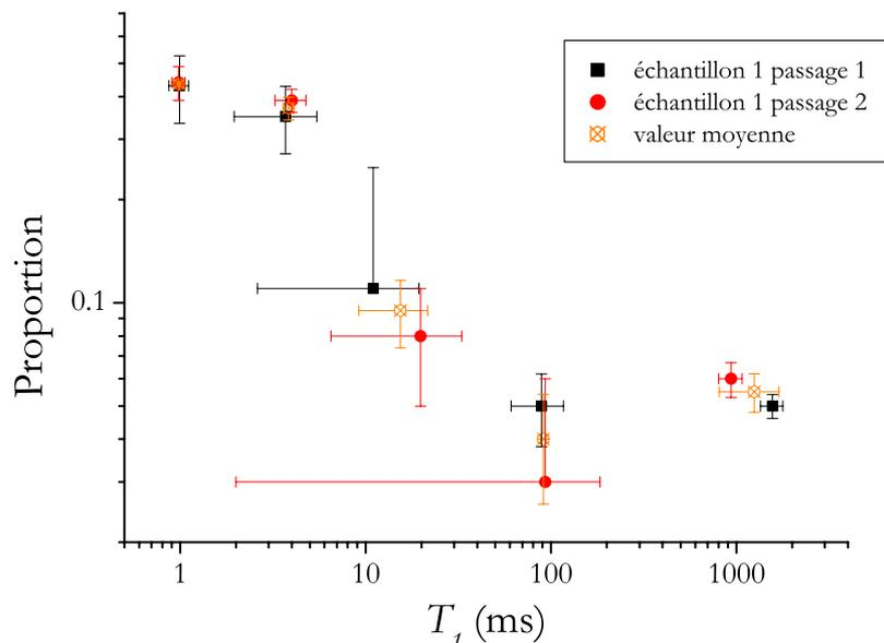
FIG. 2.15 – *Superposition des distributions de temps de relaxation obtenues par deux mesures successives de la courbe de relaxation longitudinale d'un même échantillon et de la distribution moyenne. Les mesures sont effectuées à 500 MHz, sur une pâte de  $C_3S$ -b à  $e/c = 0,4$  curée pendant 3 mois à  $20^\circ C$ .*
