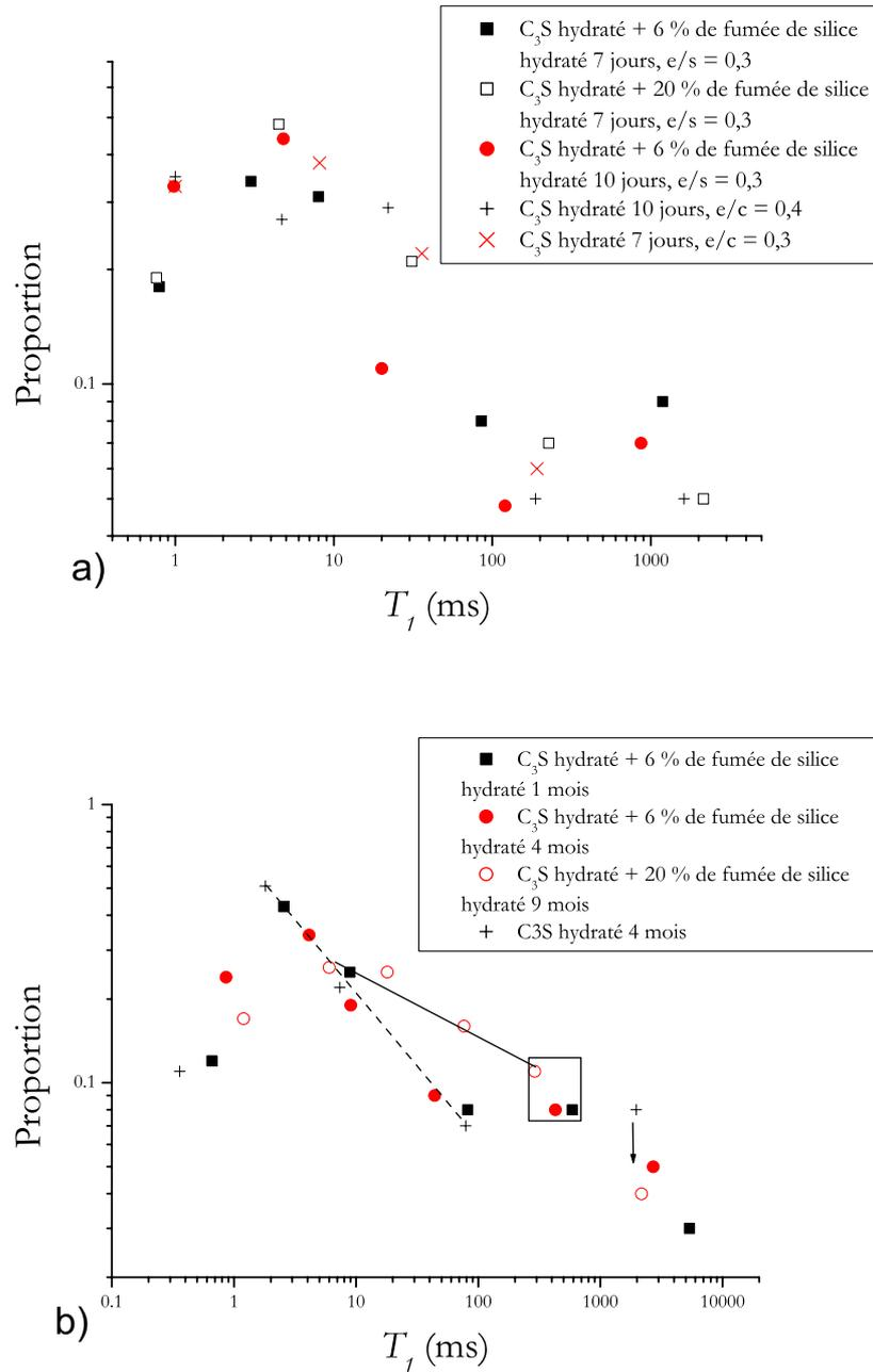
FIG. 5.11 – Distributions de temps de relaxation de pâtes de  $C_3S$ -b hydraté en fonction de la teneur en fumée de silice et du temps de cure. Les teneurs sont de 0, 6 et 20 %. Les temps de cure sont a) inférieures à 10 jours et b) supérieures à 1 mois. Les rapports  $e/s$  sont égaux à 0,3 ou 0,4.
