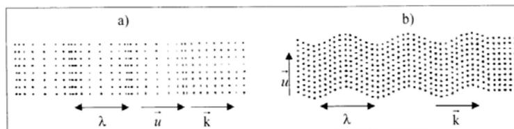
FIG. 2.19 – Schéma de la propagation d'ondes acoustiques : a) ondes longitudinales et b) ondes transverses.
