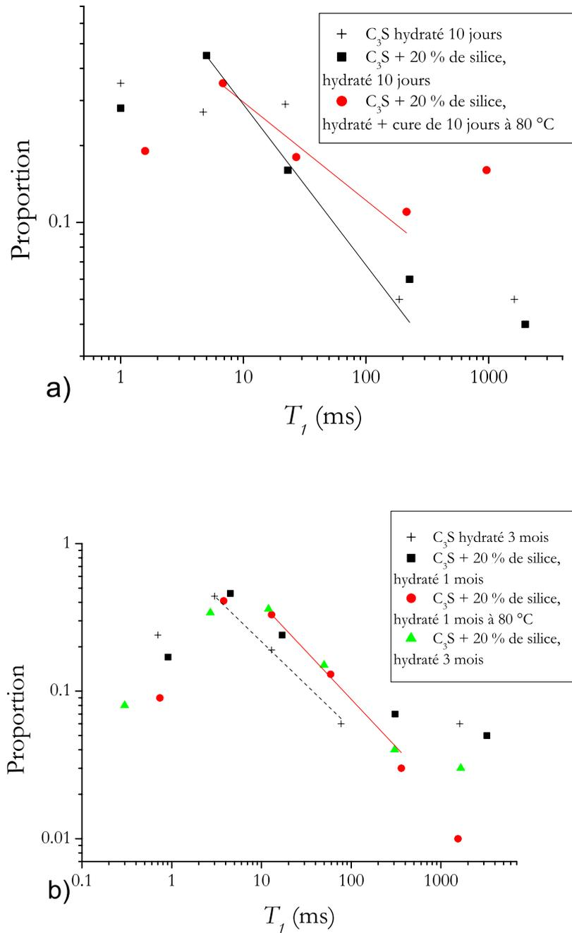
FIG. 5.12 – Distribution des temps de relaxation d'une pâte de  $C_3S$ -b hydraté, gâché avec 20 % de fumée de silice, curé à 90 °C. a) Pour un temps de cure de 10 jours et b) pour un temps de cure de 1 mois. Pour comparaison, on a superposé les distributions de pâtes de  $C_3S$ -b pures curées à 20 °C à e/c de 0,4.
