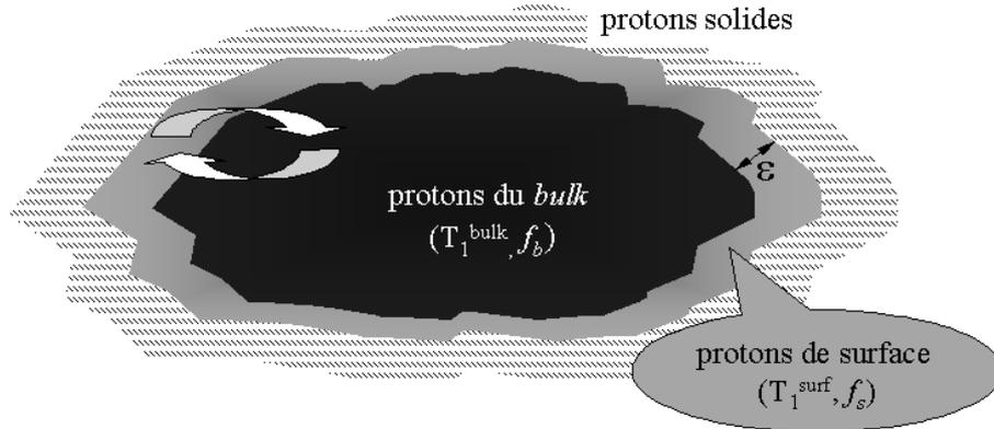
FIG. 3.1 – Schéma d'un pore vu en coupe dans lequel coexistent les phases "surface" (d'épaisseur  $\varepsilon$ ) et "bulk". Si on suppose que ces deux phases vérifient la condition d'échange biphasique rapide, la relaxation n'est caractérisée que par un seul temps de relaxation.
