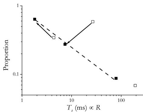
*Évolution aux temps longs de la distribution de la porosité d'une pâte de C<sub>3</sub>S entre la dissociation et l'établissement d'une loi de puissance.*
