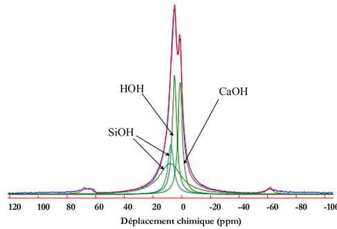
*Spectre RMN proton à 500 MHz avec rotation à l'angle magique à 30 kHz d'une pâte de C<sub>3</sub>S et ajustement par quatre raies.*
