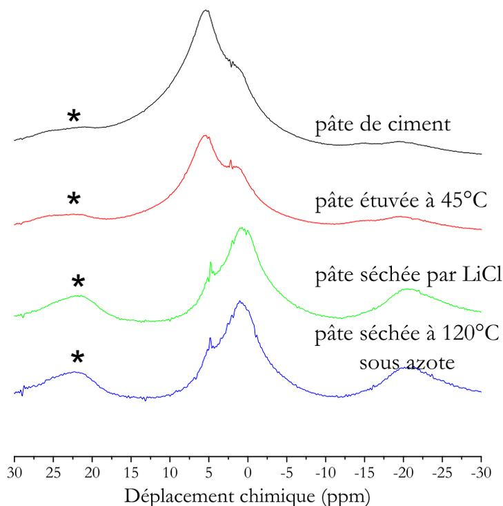
FIG. 2.5 – Spectres  $^1H$  MAS d'une pâte de  $C_3S$ -b hydraté 3 mois ayant subi différents mode de séchage. Réalisés sur spectromètre 500 MHz à 10 kHz de rotation. Les pics marqués par \* sont des bandes de rotation.
