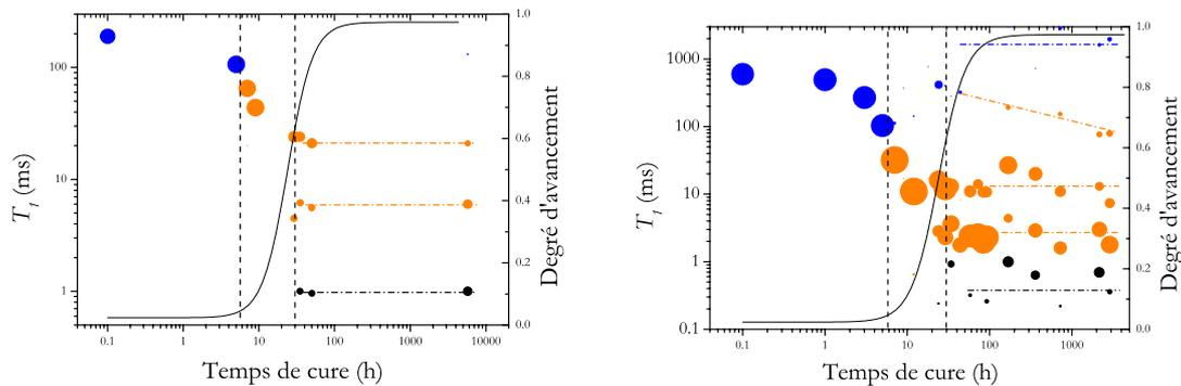
FIG. 4.4 – Évolution en fonction du temps de cure des décompositions en  $T_1$  mesurées a) à 100 MHz sur  $C_3S$ -a hydraté et b) à 500 MHz sur  $C_3S$ -b hydraté ;  $e/c = 0,4$ . La taille des points est fonction de la proportion relative de chaque famille. On retrouve les trois phases d'évolution observées précédemment mais la différenciation des échelles de porosité est plus efficace.
