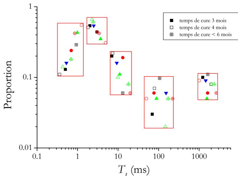
FIG. 2.16 – Superposition des distributions de temps de relaxation calculées pour des pâtes de C<sub>3</sub>S-b hydraté plus de 1 mois à 20 °C ;  $e/c = 0,4$ .
