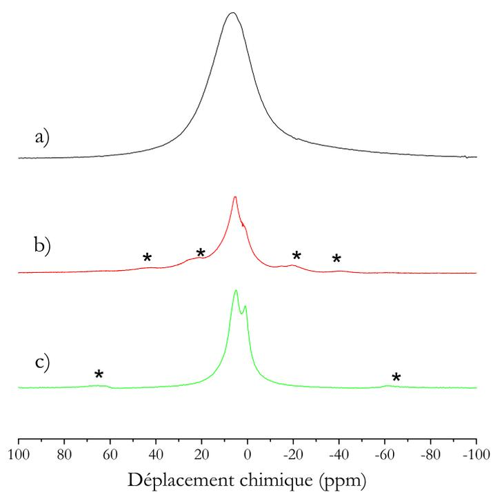
FIG. 2.2 – Spectres  $^1\text{H}$  a) statique et MAS, à b) 10 et c) 30 kHz, d'une pâte de  $\text{C}_3\text{S-b}$  hydraté, réalisés sur spectromètre 500 MHz. La rotation permet l'affinement des pics. Les pics marqués par \* sont des bandes de rotation.
