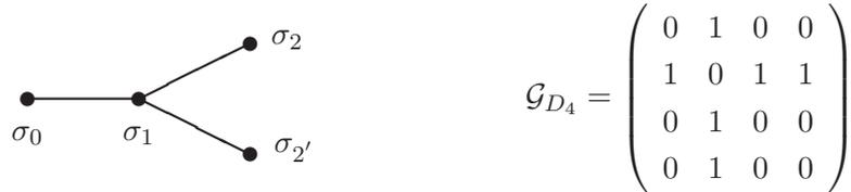
FIG. 4.10 – Le grphe  $D_4$  et sa matrice d'adjacence.
