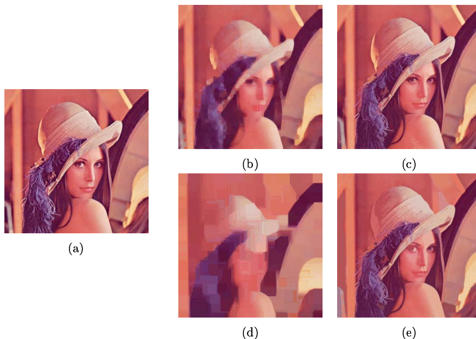
FIG. 4.14 – Nivellements couleur de l'image "lenna" avec l'ordre \Omega \equiv (I|_{\alpha=10} \rightarrow R \rightarrow G \rightarrow B) : (a) image de référence, \mathbf{f} ; (b) image marqueur (FAS de taille 5), \mathbf{m}_1 ; (c) image nivelée, \lambda_{\Omega}(\mathbf{f}, \mathbf{m}_1) ; (d) image marqueur (FAS de taille 15), \mathbf{m}_2 ; (e) image nivelée, \lambda_{\Omega}(\mathbf{f}, \mathbf{m}_2) .
