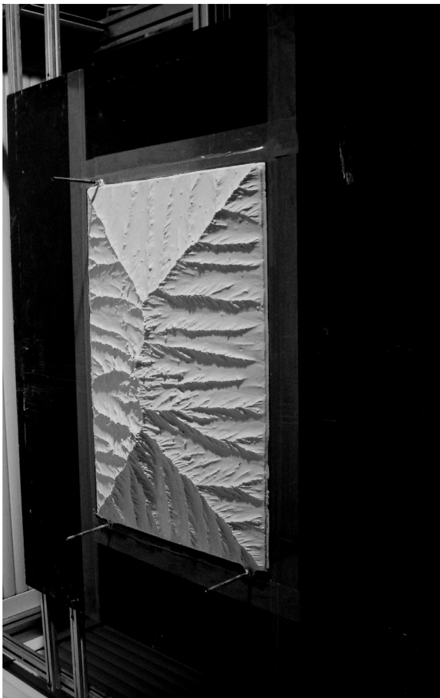
Figure 18: Topographie à l'équilibre stationnaire de l'expérience B6 entouré d'un plateau de 250 mm de large correspondant à la topographie initiale de l'expérience P5.
