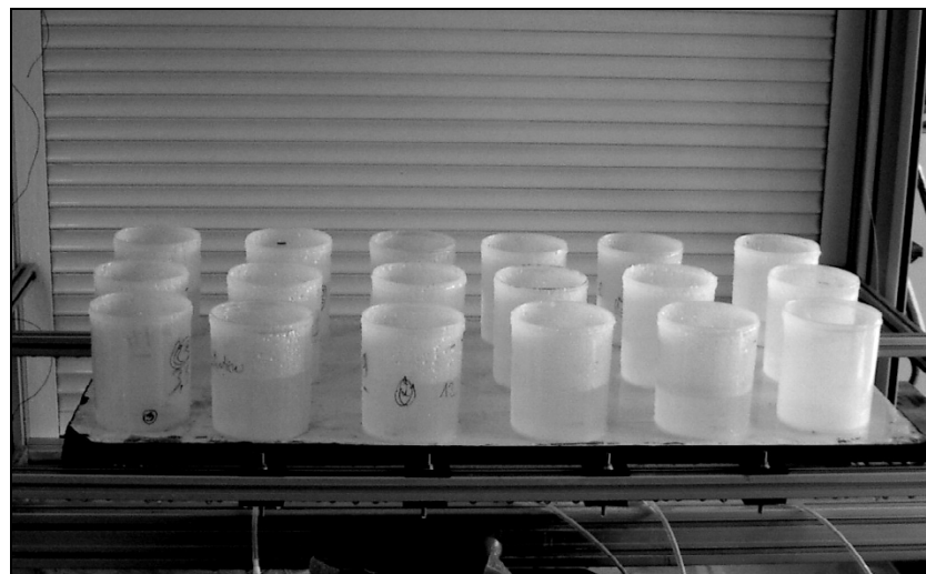
Figure 6 : Mesure de la pluviométrie pour calibrer l'homogénéité spatiale de la pluie avant chaque expérience.
