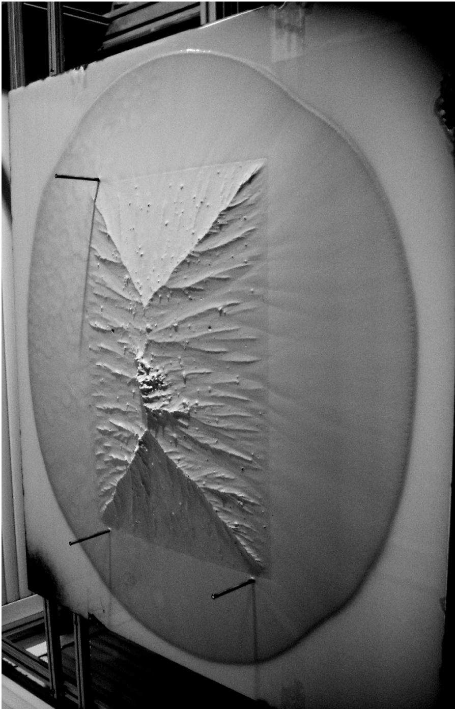
Figure 19: Expérience P5 à t = 720 min. La topographie initiale a été totalement lissée, seul un faible relief persiste.
