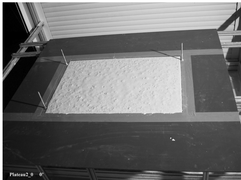
Figure 5: La boîte à érosion, ici dans le simulateur à brouillard, est entourée d'un plateau composé de plaques de PVC. C'est sur ce plateau que les produits d'érosion s'accumuleront.
