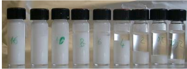
FIG. 1.26: Effet de la fraction volumique sur la hauteur de sédimentation de particules de silice (400nm de diamètre) en présence de calcium (de droite à gauche 0,3, 0,75, 2,9, 5,9, 8,9, 15, 18, 21, 24%), pH 10 + [\text{Ca}^{2+}] = 0,1 \text{ mol/l} .
