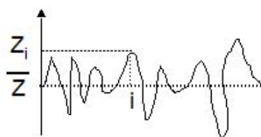
FIG. 2.31: Représentation schématique de la valeur moyenne et valeur au point i d'un profil de surface rugueuse.
