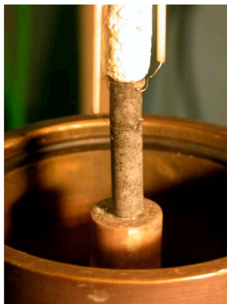
*Figure 3.11 : montage de la méthode Angström linéaire dans l'appareil de déformation et photo de l'échantillon en position de mesure.*
