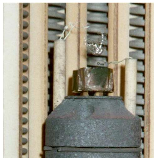
**Figure 3.8 :** Montage expérimental de la méthode 2 et photo montrant la disposition de l'échantillon dans le four (monocristal d'olivine).
