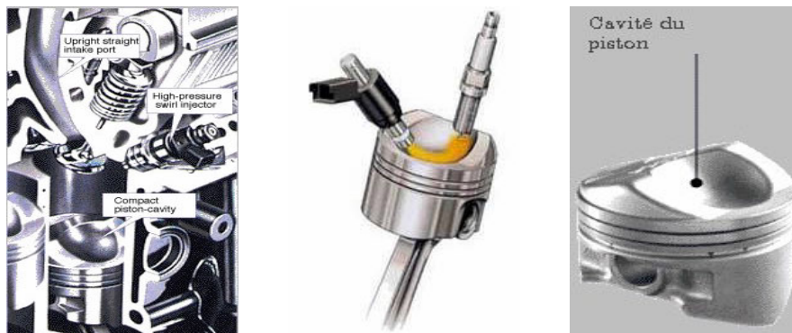
FIG. 1.5 – Cavité de la tête du piston du moteur à injection directe essence
