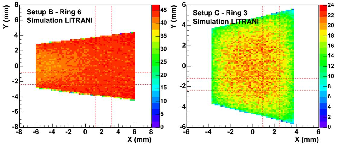
**FIG. 3.22:** Distribution de la lumière (en photo-électrons) en fonction de la position en X et Y de l'impact des particules sur les éléments de scintillateurs, obtenue par simulation avec le programme LITRANI. Les distributions sont normalisées avec le nombre de photo-électrons obtenu expérimentalement. La figure de gauche est la distribution obtenue pour un élément du Setup B, la figure de droite pour un élément du Setup C.
