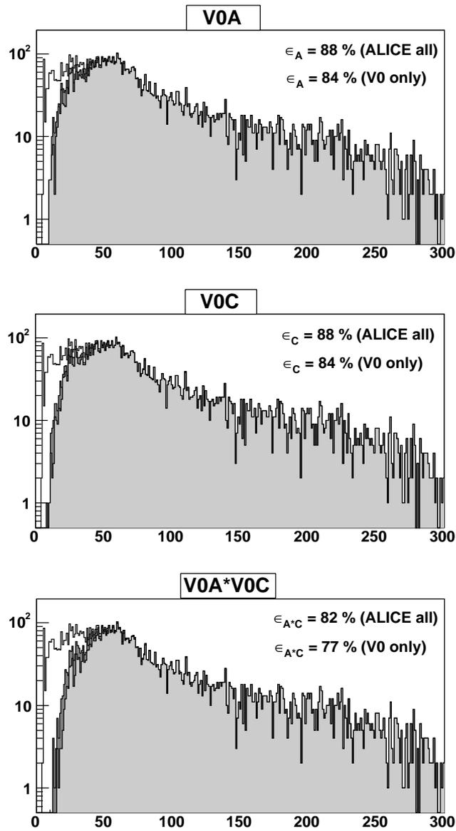
**FIG. 4.6:** Efficacité de déclenchement du V0 sur les événements p-p inélastiques. Les différentes distributions donnent la multiplicité des événements p-p donnant lieu à un déclenchement du V0A (en haut), du V0C (au milieu) et à une coïncidence V0A\*V0C (en bas). Dans chacun des cas, la distribution en blanc est la multiplicité des événements p-p donnée par PYTHIA, en gris foncé en considérant le V0 seul et en gris clair en ajoutant l'effet de l'environnement du V0.
