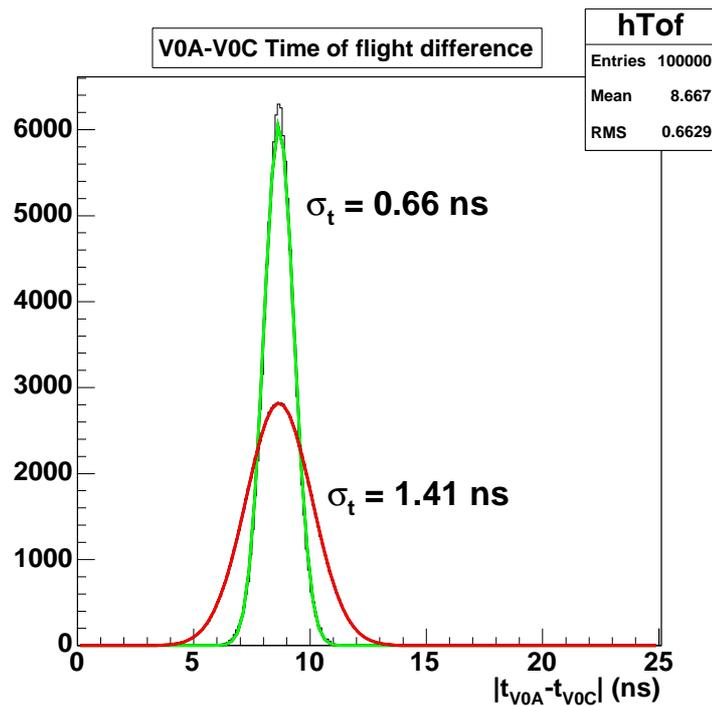
**FIG. 4.21:** Distribution de la différence de temps de vol obtenue avec un étalement gaussien du temps de  $\sigma = 1$  ns. La résolution en temps diminue si l'on sélectionne le meilleur hTof obtenu parmi 48 valeurs pour le V0A et V0C.
