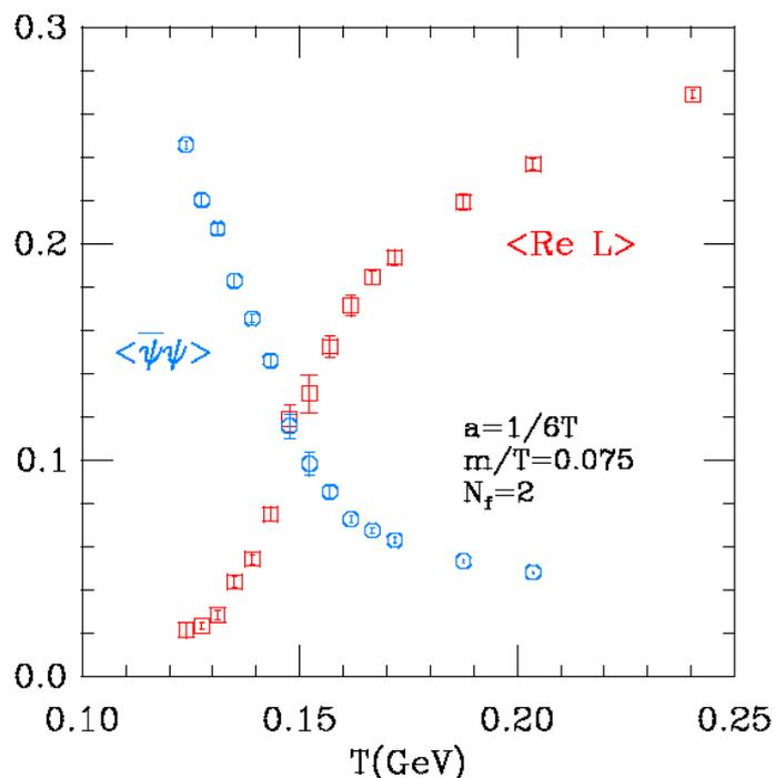
**FIG. 1.2:** Dépendance du condensat quark-antiquark  $\langle \bar{\psi}\psi \rangle$  (paramètre d'ordre de la symétrie chirale) avec la température du milieu (cercles). La quantité  $\langle \text{Re } L \rangle$  est le paramètre d'ordre du déconfinement. Figure tirée de la référence [6].
