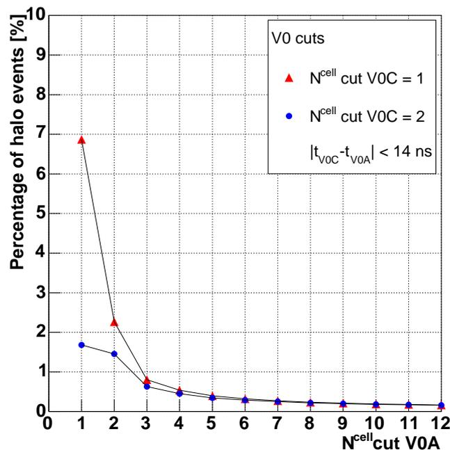
**FIG. 4.19:** Distribution du pourcentage d'événements de halo détectés en coïncidence dans le V0 en fonction de la coupure sur le nombre de cellules du V0A. La coupure sur la différence de temps de vol est fixée à 14 ns.
