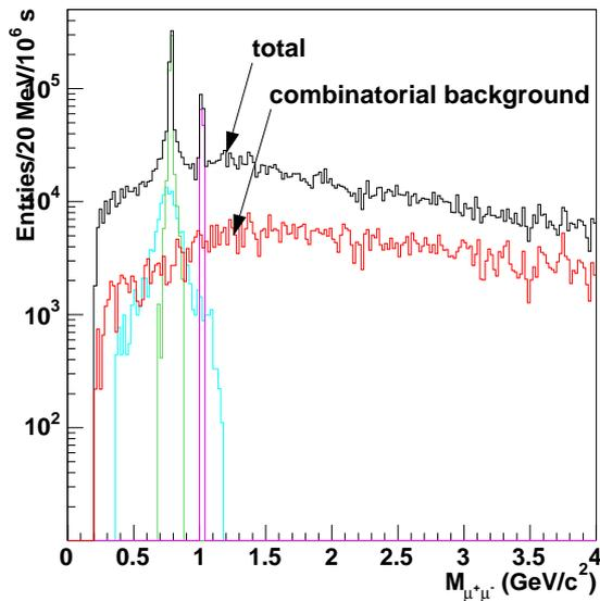
**FIG. 6.7:** Spectres en masse invariante des processus corrélés et non-corrélés. La distribution nommée "combinatorial background" désigne le bruit de fond combinatoire évalué par "event-mixing". La distribution nommée "total" est la somme des processus de la figure 6.6 et du bruit de fond combinatoire.
