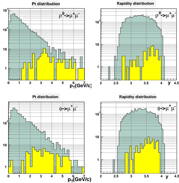
**FIG. 6.4:** Efficacité de reconstruction du méson  $\rho^0$  (haut) et  $\phi$  (bas). Les distributions en impulsion transverse sont tracées du côté gauche, les distributions en rapidité du côté droit. En gris foncé, les distributions générées avec PYTHIA et en gris clair les distributions après reconstruction des traces dans le spectromètre.
