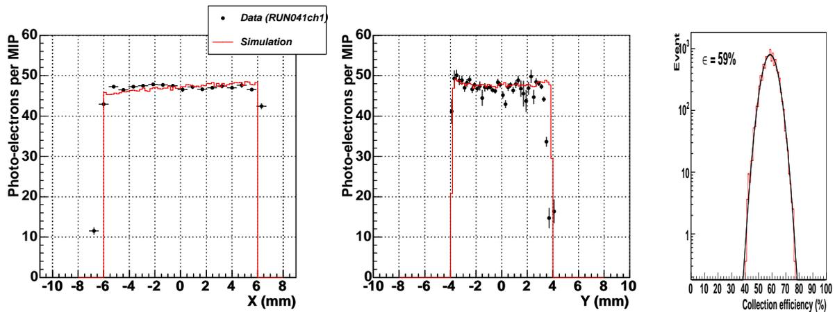
**FIG. 3.23:** Distributions de la lumière récoltée en fonction de la position selon les axes X et Y, pour la couronne 5 du Setup B. A gauche, projection selon l'axe vertical défini au paragraphe précédent. Au centre selon l'axe horizontal. Les points représentent les résultats expérimentaux avec leur erreurs, le trait plein le résultat de la simulation avec LITRANI. A droite, efficacité de collection de la lumière de scintillation.
