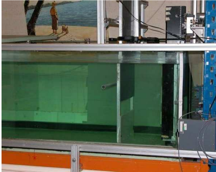
FIG. 4.1 – Photographie de la cuve dans la salle expérimentale du LadHyX (septembre 2003). On voit à droite le dispositif pour générer le dipôle décrit dans la section suivante.
