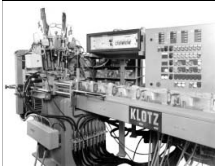
Figure 2.5 : Machine semi-automatisée avec un dispositif de transfert pour le montage des culasses chez KLOTZ®
