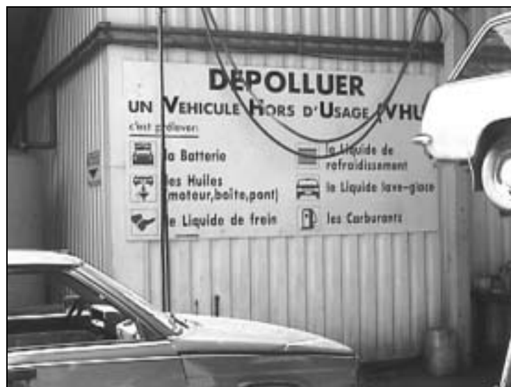
Figure 1.12 : Principaux éléments de dépollution des véhicules hors d'usage
