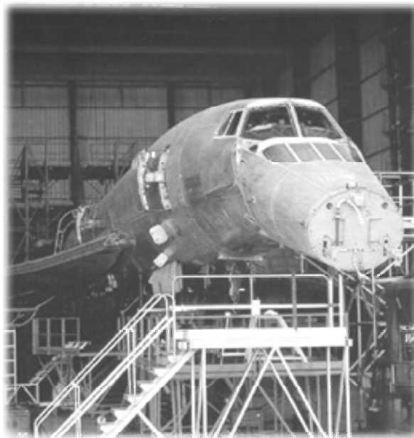
Figure 2.18 : Démontage d'un Concorde en vue de sa maintenance
