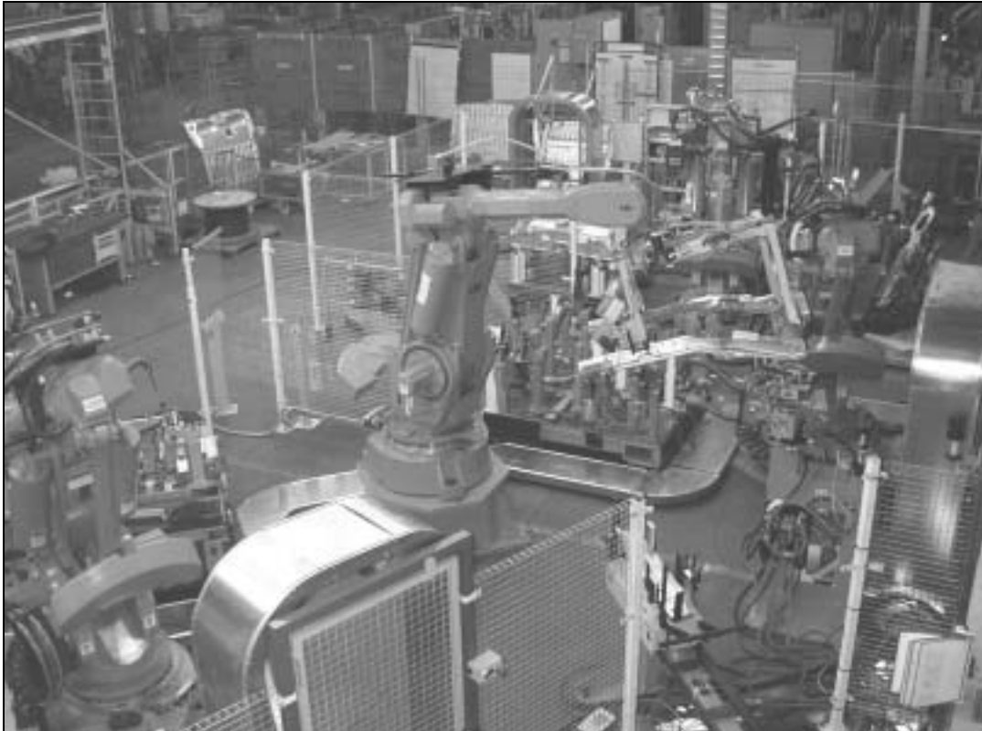
Figure 2.7 : Lignes d'assemblage (Ilots robotisés, soudure SR/MAG) pour unité arrière T16 (Peugeot® Cabriolet 206)
