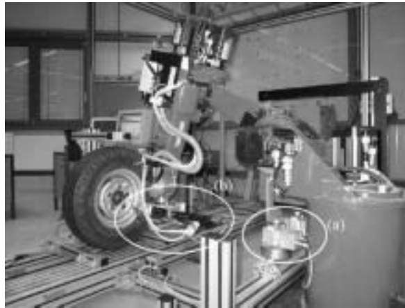
– a – Système de vision stéréo, – b – outils de dévissage sur le robot
