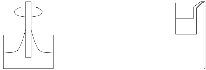
FIG. 1.3 – Représentation schématique de deux comportements surprenants des fluides polymériques : le rod-climbing effect (à gauche) et le open syphon effect (à droite).
