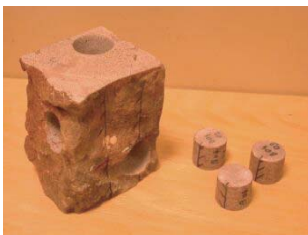
Fig. 6.6 - Photographie d'un bloc de roche vitrolleuse dont trois faces ont été dressées afin d'assurer la perpendicularité entre les axes des échantillons prélevés.
