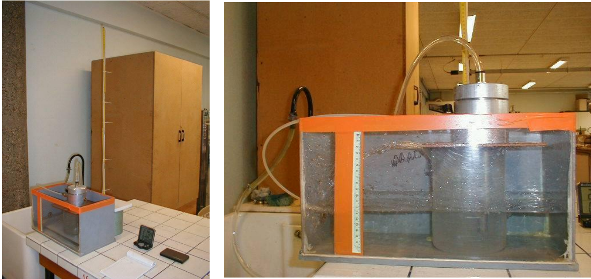
figure 2-7, vues du dispositif d' étalonnage de la sonde
