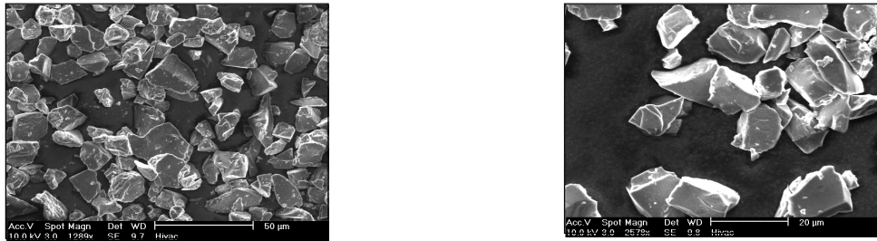
figure 3-25 : image MEB des grains d'abrasifs usés, les arêtes des grains restent tranchantes
